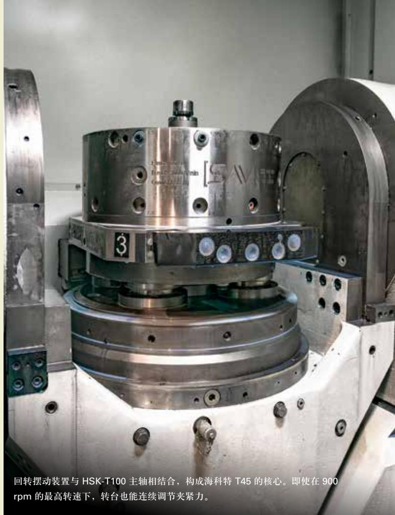
回转摆动装置与 HSK-T100 主轴相结合，构成海科特 T45 的核心。即使在 900 rpm 的最高转速下，转台也能连续调节夹紧力。
