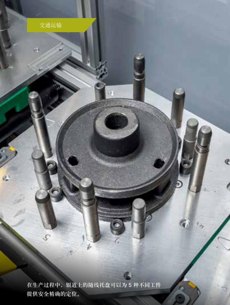
在生产过程中，辊道上的随线托盘可以为 5 种不同工件提供安全精确的定位。
