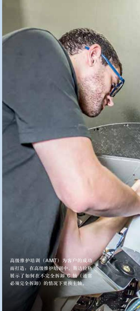
高级维护培训（AMT）为客户的成功而打造：在高级维护培训中，斯达拉格展示了如何在不完全拆卸 C 轴（通常必须完全拆卸）的情况下更换主轴。
