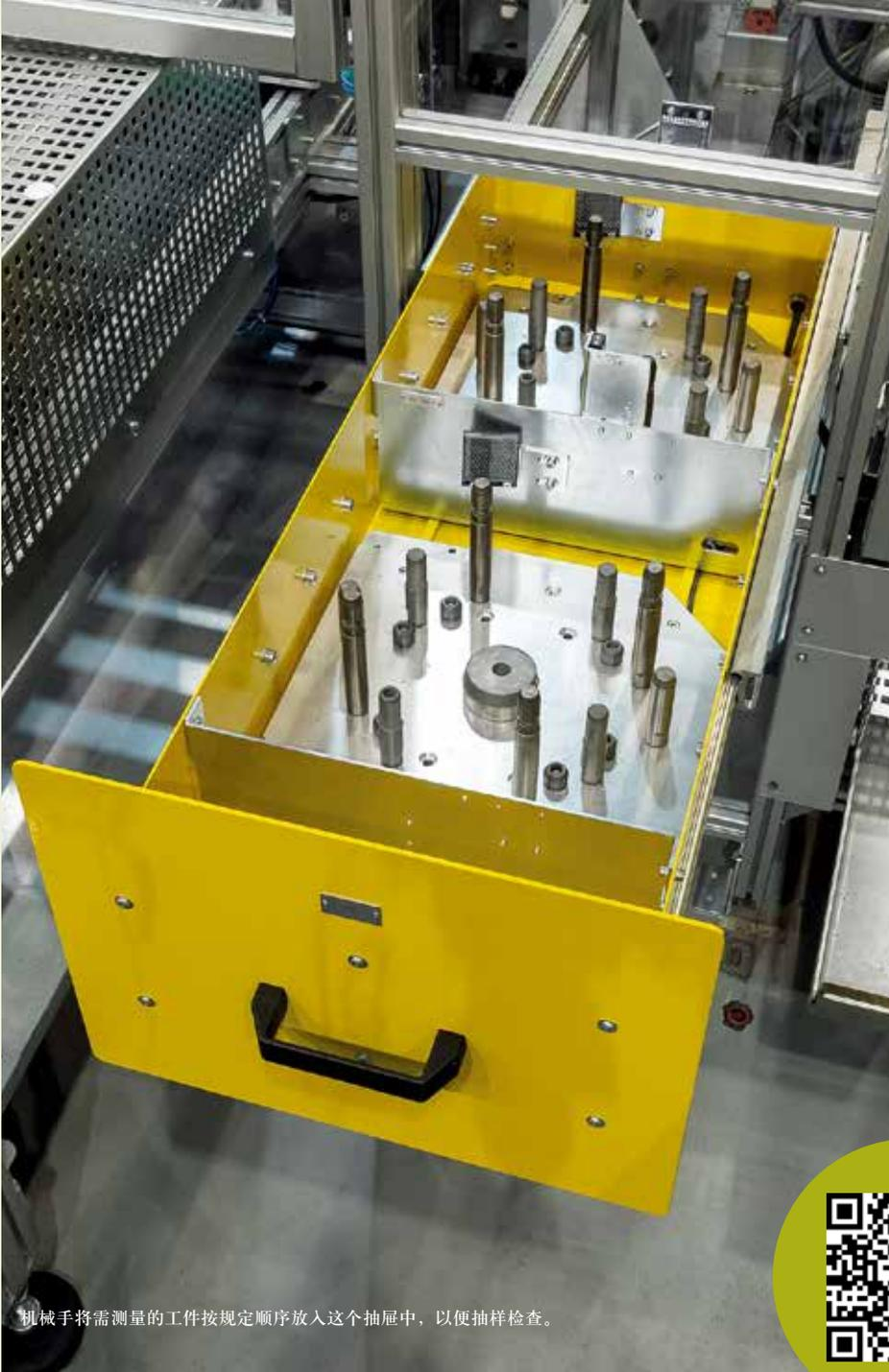
机械手自动装配与工件相匹配的夹爪。还可以使用专用附件快速更换随线夹具。
