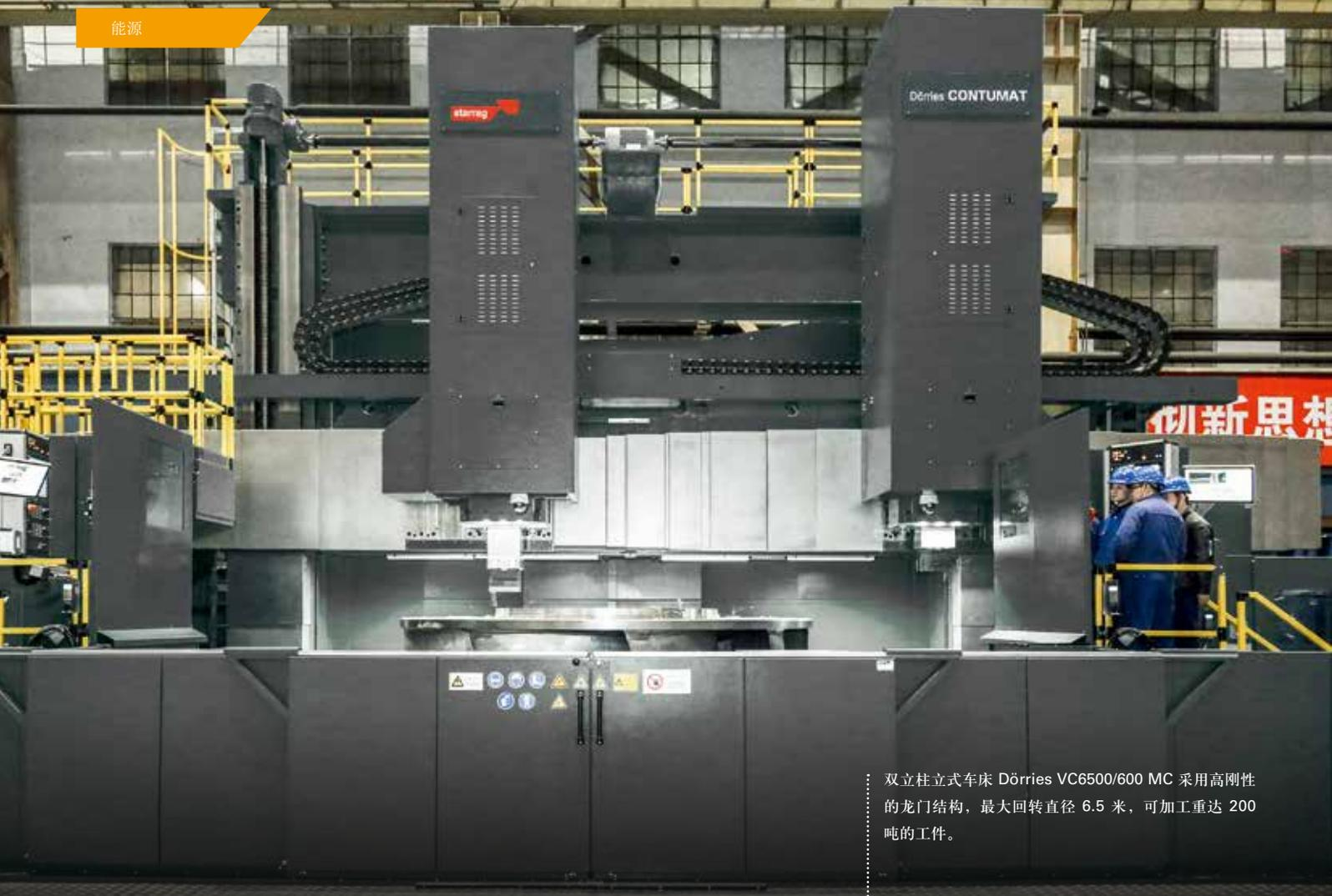
双立柱立式车床 Dörries VC6500/600 MC 采用高刚性的龙门结构，最大回转直径 6.5 米，可加工重达 200 吨的工件。
