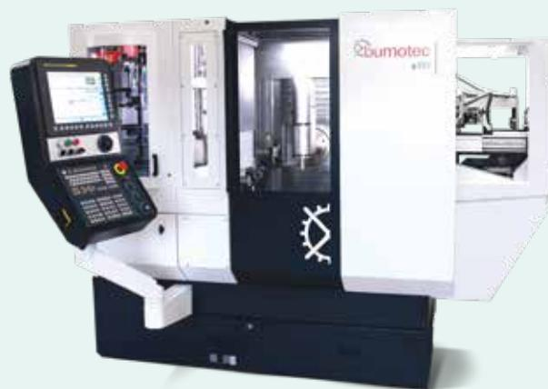
s191 是一个整体加工解决方案，可加工棒料（ $\varnothing 32/50/65$  mm）或坯料，带有快速直线轴和主轴，能在 2 秒内达到 30,000 rpm 的转速，总共有 7 个轴、3 个主轴和 90 把刀具——简而言之，是加工中心界的“圣杯”。
