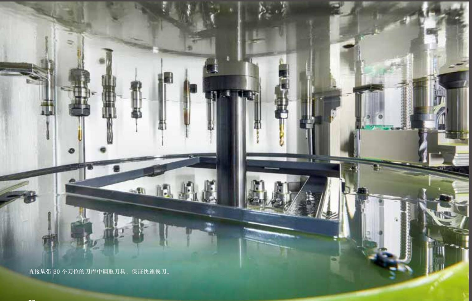
直接从带 30 个刀位的刀库中调取刀具，保证快速换刀。
