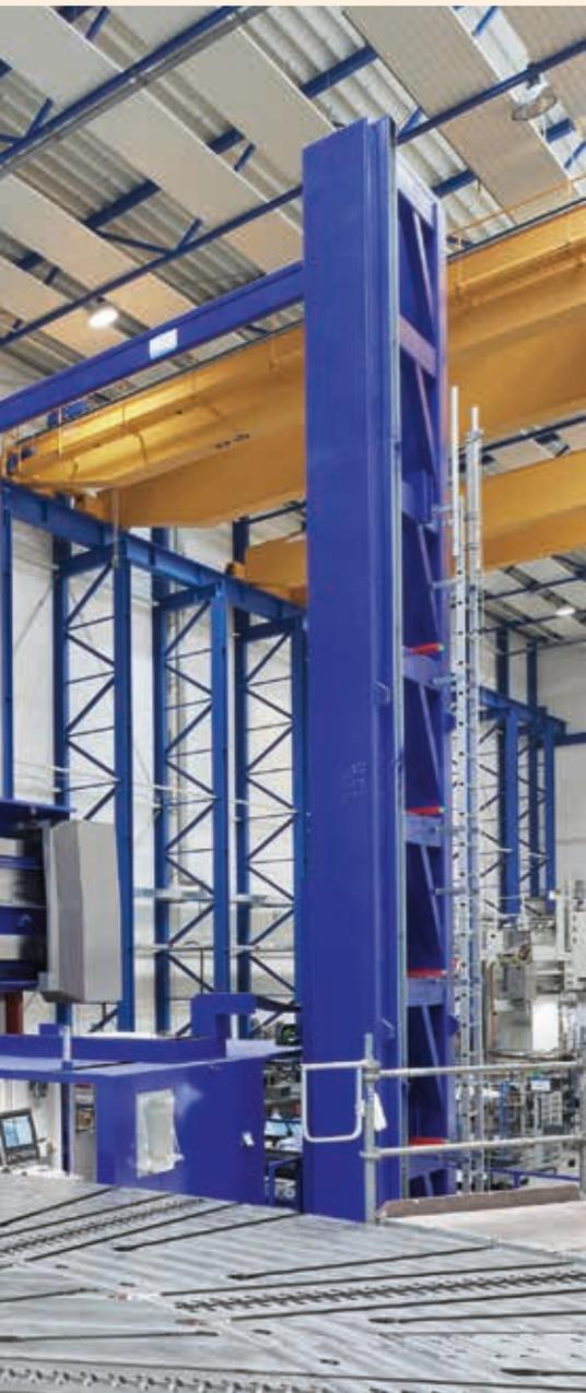
**Grande commande danoise :** une fraiseuse à portique Gantry est en cours de fabrication à Bielefeld. Elle permet de tourner, de fraiser et de percer avec une puissance élevée les plus grands éléments de construction en acier soudé et en fonte très résistants.
