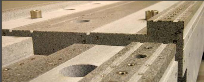
由于花岗岩的固有特性，它是制造高精度测量和生产设备的理想材料。花岗岩的减振能力比铸铁或钢高三到四倍。钢和铸铁受到膨胀系数的影响也是花岗岩的两倍。
