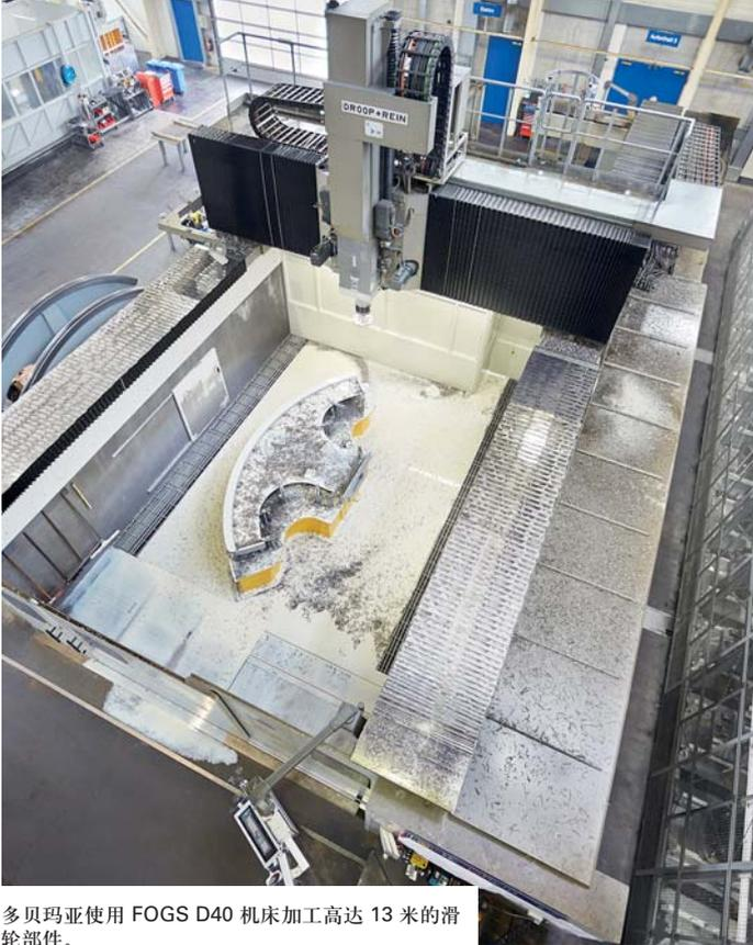
多贝玛亚使用 FOGS D40 机床加工高达 13 米的滑轮部件。
