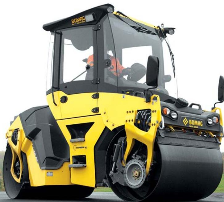
宝马格串联式压路机，用于压实沥青路面
