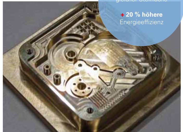
Demonstrationsteil, 2,5 Minuten Zykluszeit zur kompletten Bearbeitung aus dem Vollen.
