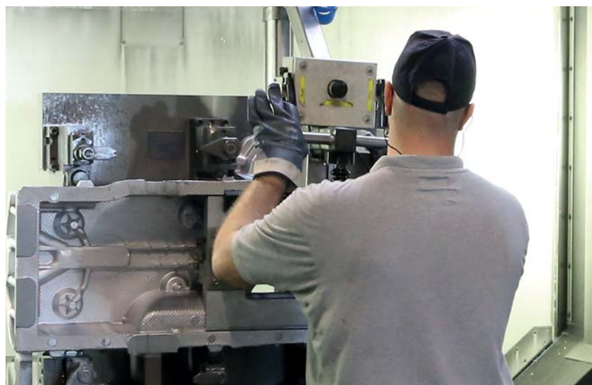
装卸站完全向上开口，允许在加工期间轻松装卸
