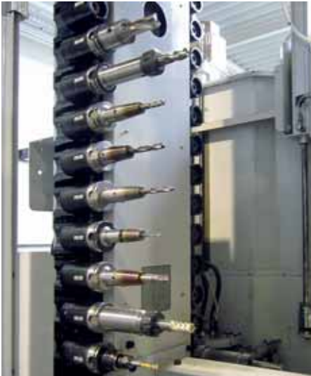
Le changement d'outil ne met pas le processus en danger, étant donné que le magasin à chaîne de l'HEC 500 D est une zone sans liquide de coupe ni copeaux
