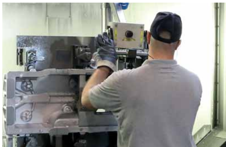
La partie supérieure de la station de chargement est entièrement ouverte, ce qui permet un chargement en temps masqué facile de la machine
