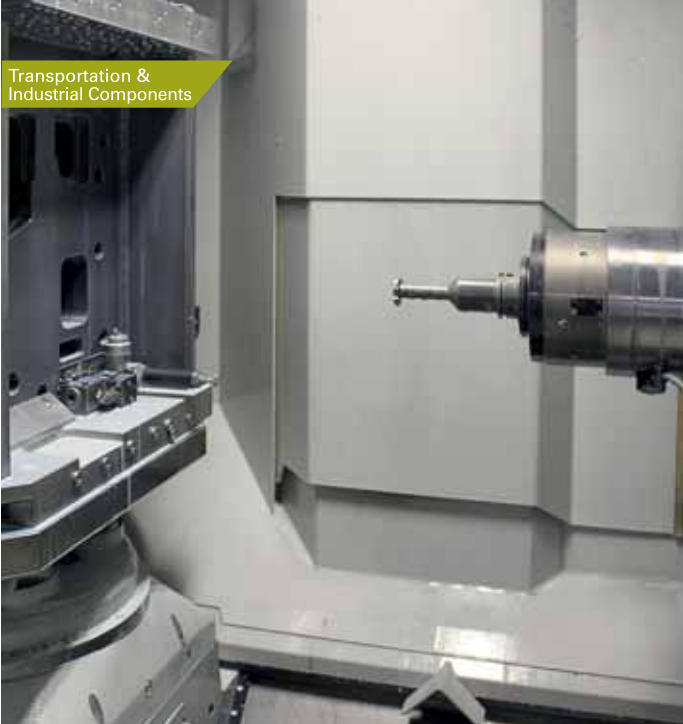
Dans l'espace de travail en forme d'entonnoir du HEC 500 D, les copeaux tombent directement dans le ramasse-copeaux placé au centre, évitant ainsi tout entassement de copeaux
