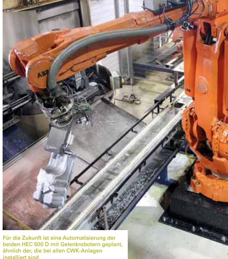
Für die Zukunft ist eine Automatisierung der beiden HEC 500 D mit Gelenkrobotern geplant, ähnlich der, die bei allen CWK-Anlagen installiert sind
