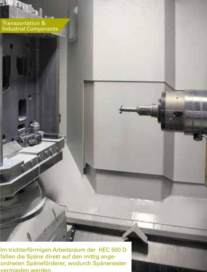
Im trichterförmigen Arbeitsraum der HEC 500 D fallen die Späne direkt auf den mittig angeordneten Späneförderer, wodurch Spänenester vermieden werden
