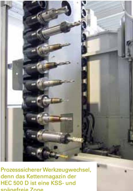
Prozesssicherer Werkzeugwechsel, denn das Kettenmagazin der HEC 500 D ist eine KSS- und spänefreie Zone
