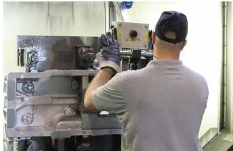
Die Beladestation ist nach oben komplett geöffnet und ermöglicht ein einfaches, hauptzeitparalleles Beladen der Maschine
