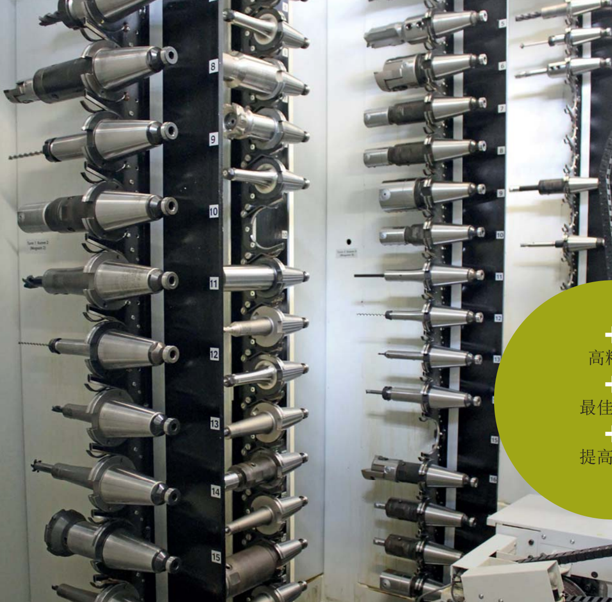
CVS 安装的海科特塔式刀库共有 240 个刀位，甚至可以容纳长达 800 mm、直径达 340 mm、单个重量达 50 kg 的超大超重刀具。
