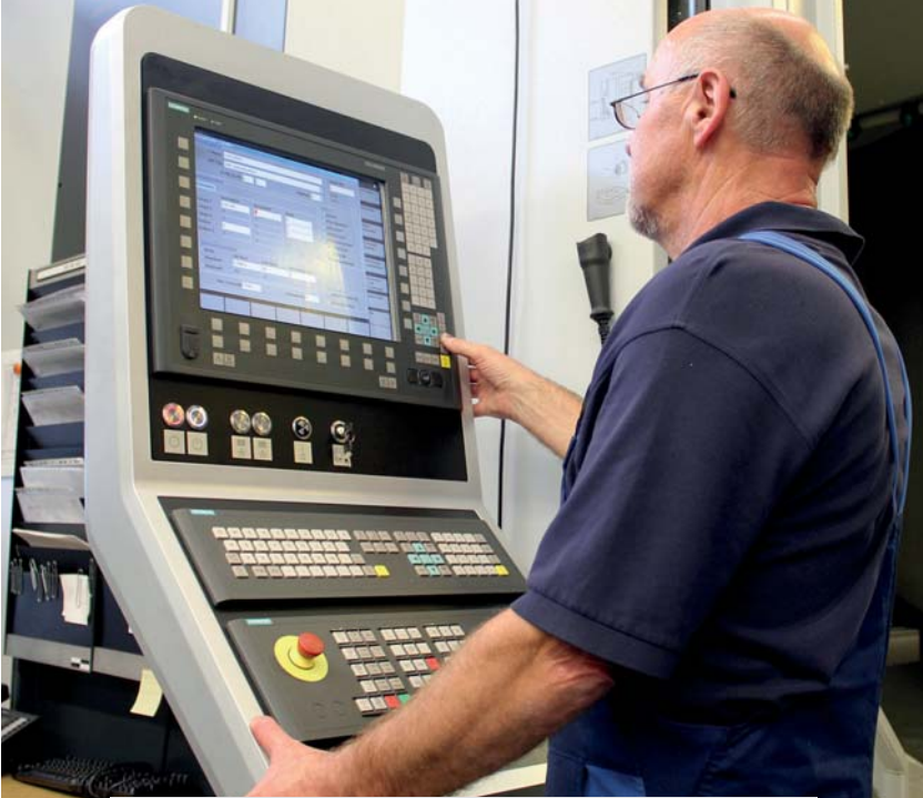
海科特 HEC 630 Athletic 卧式加工中心采用西门子 840 D sL 数控系统。数控系统具有高易用性，深受 CVS 工作人员的好评
