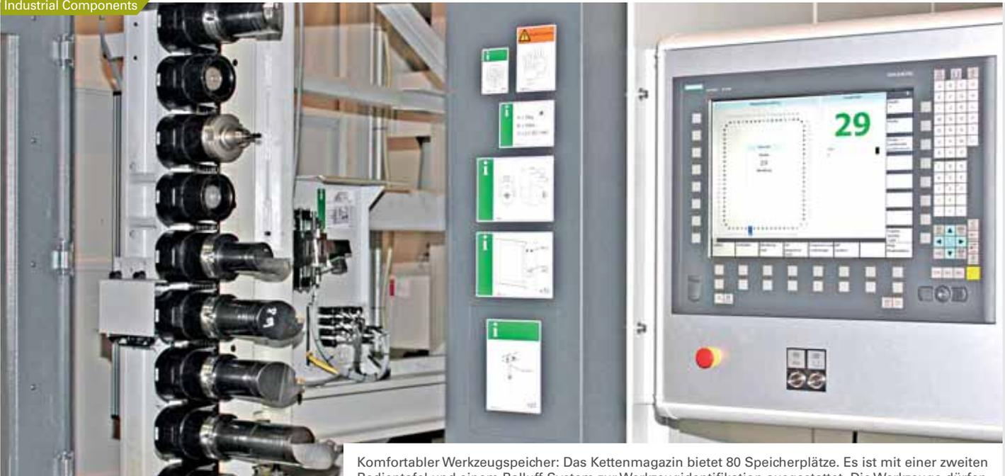
Komfortabler Werkzeugspeicher: Das Kettenmagazin bietet 80 Speicherplätze. Es ist mit einer zweiten Bedientafel und einem Balluff-System zur Werkzeugidentifikation ausgestattet. Die Werkzeuge dürfen eine Länge bis 450 mm, ein Gewicht bis 35 kg und 50 Nm Kippmoment aufweisen
