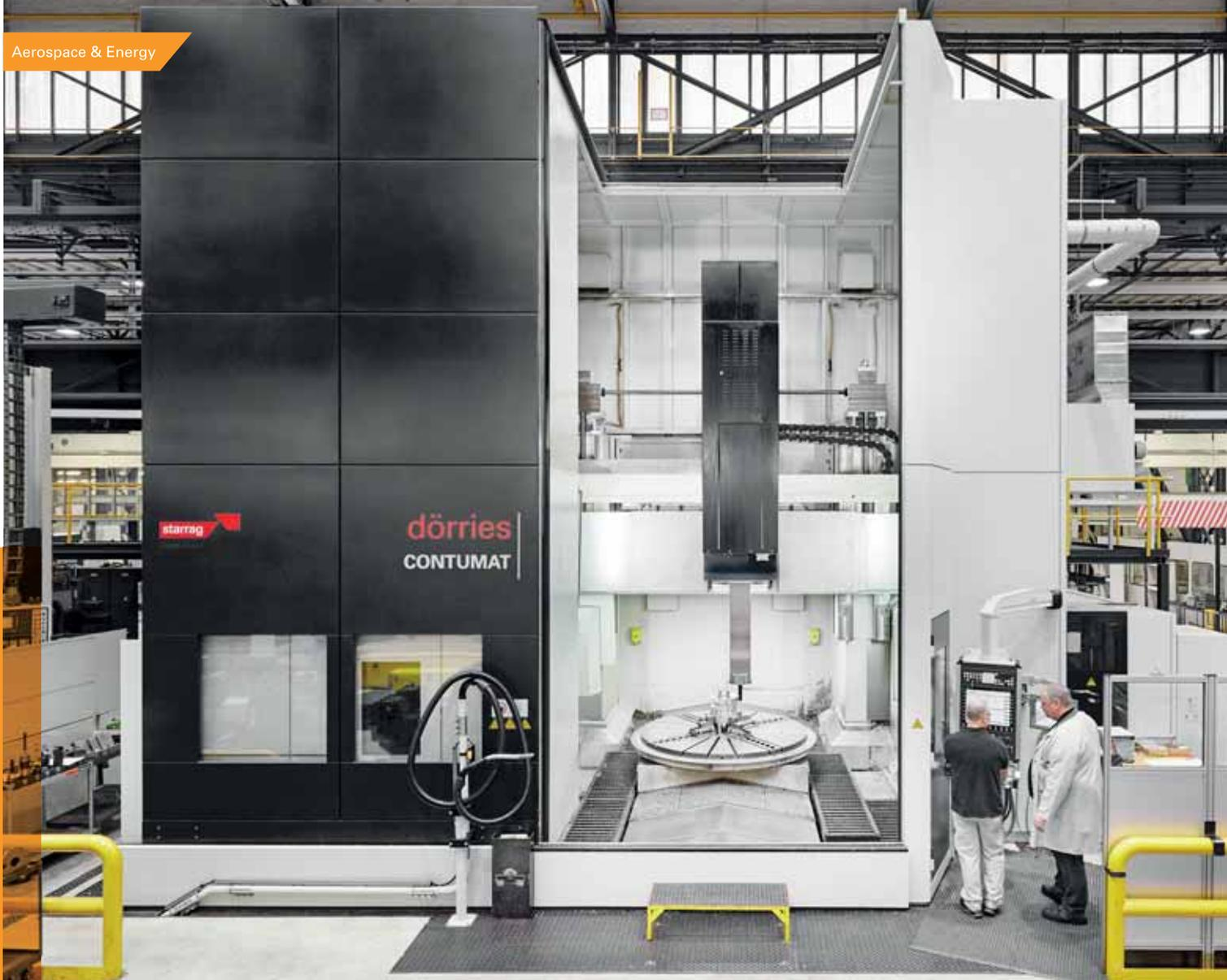
Komplettbearbeitung«, ergänzt die Leiterin der mechanischen Fertigung. »Wir können nun in einer Aufspannung drehen, bohren, fräsen und schleifen.«
