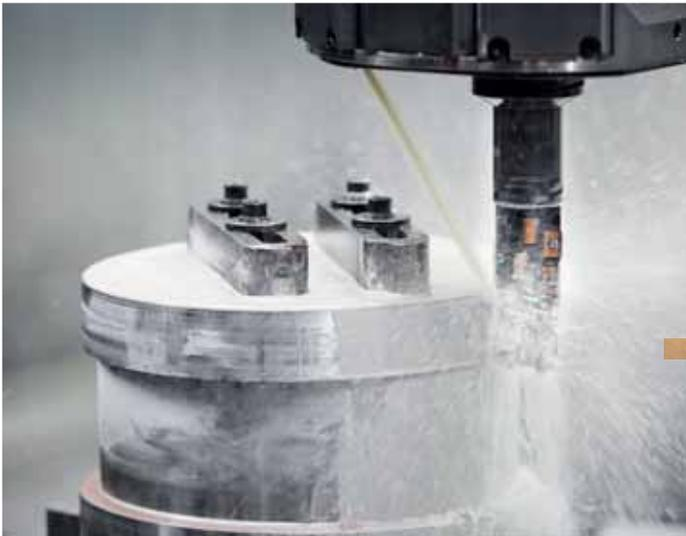
**Komplett bearbeitet:** Dank Zerspanung in einer Aufspannung (hier die Bearbeitung eines elliptischen Bauteils) sank die Durchlaufzeit auf der CONTUMAT um mindestens 30 %
