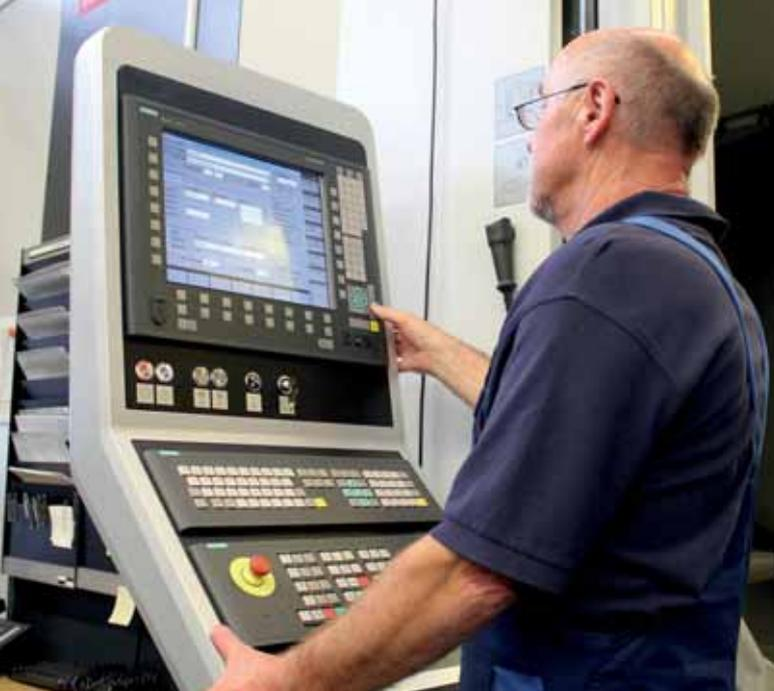
Das horizontale Bearbeitungszentrum HEC 630 Athletic von Heckert wird von einer Siemenssteuerung 840 D sl gesteuert. Die CNC bietet hohen Bedienkomfort, den die Mitarbeiter bei CVS zu schätzen wissen
