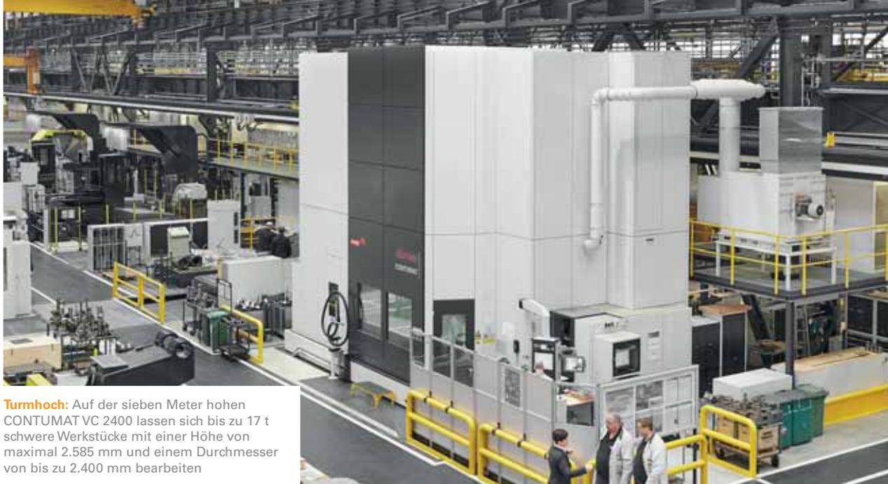
**Turmhoch:** Auf der sieben Meter hohen CONTUMAT VC 2400 lassen sich bis zu 17 t schwere Werkstücke mit einer Höhe von maximal 2.585 mm und einem Durchmesser von bis zu 2.400 mm bearbeiten
