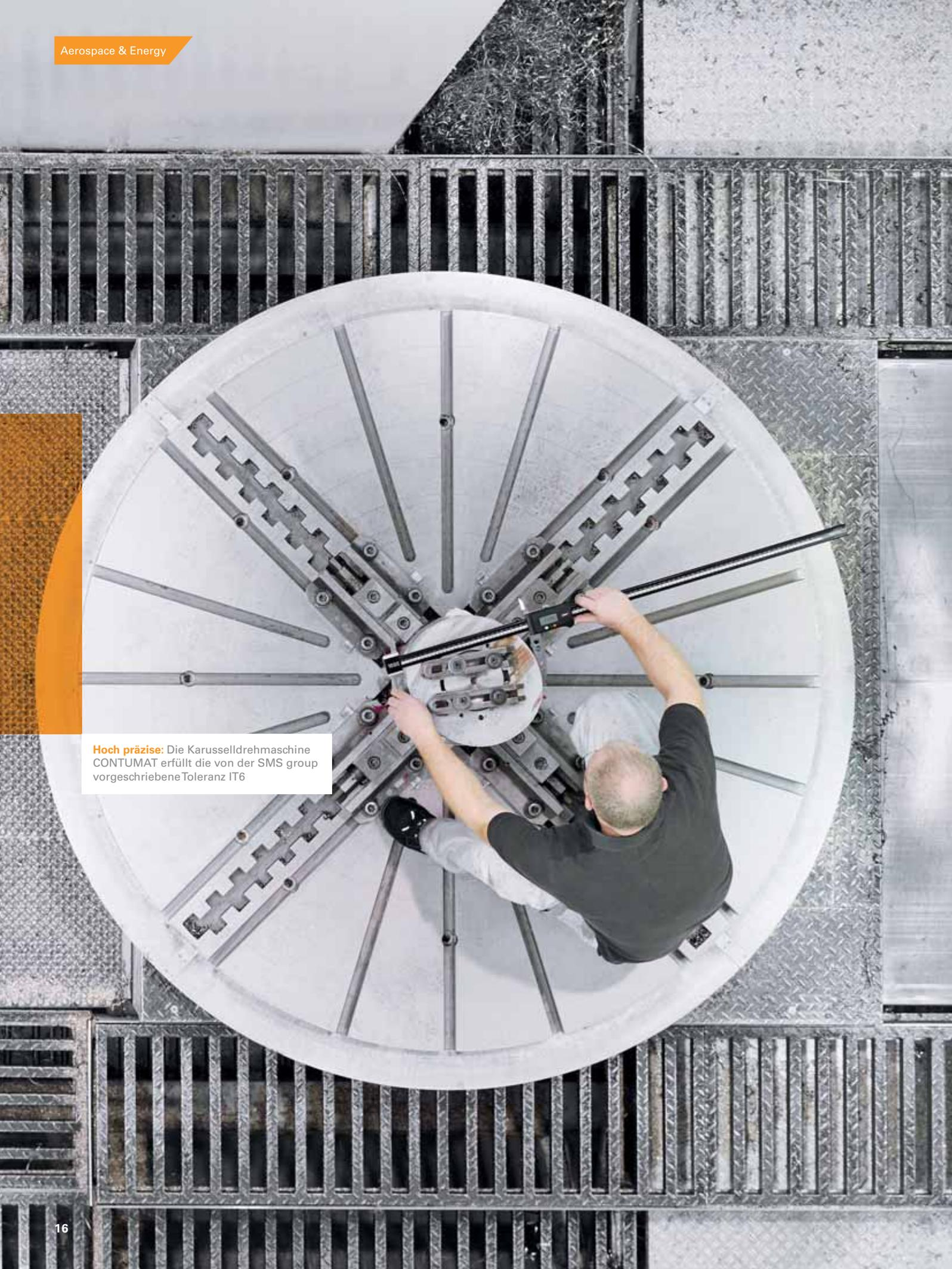
**Hoch präzise:** Die Karusselldrehmaschine CONTUMAT erfüllt die von der SMS group vorgeschriebene Toleranz IT6
