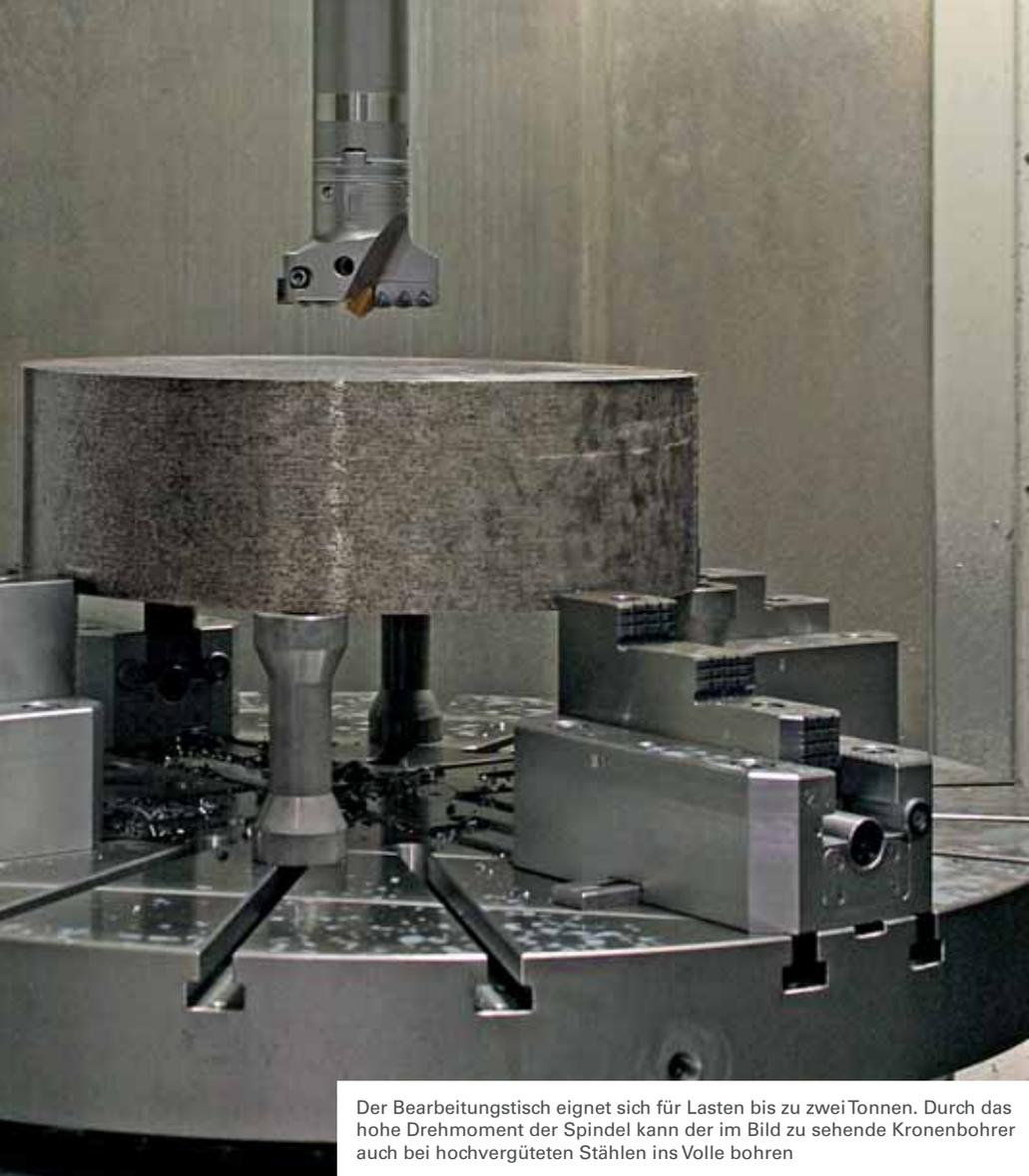
Der Bearbeitungstisch eignet sich für Lasten bis zu zwei Tonnen. Durch das hohe Drehmoment der Spindel kann der im Bild zu sehende Kronenbohrer auch bei hochvergüteten Stählen ins Volle bohren
