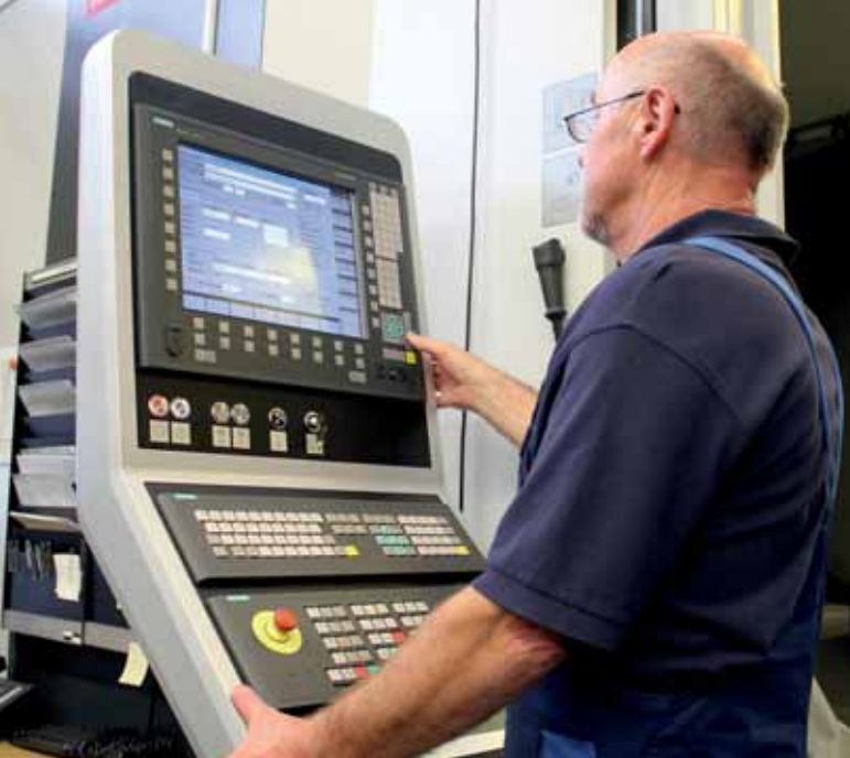
Le centre d'usinage horizontal HEC 630 Athletic de Heckert est piloté par une commande Siemens 840 D sL. La CNC offre un confort d'utilisation élevé, qui est apprécié par le personnel de CVS
