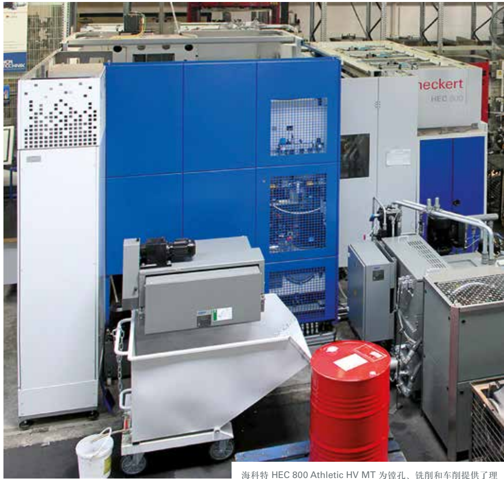
海科特 HEC 800 Athletic HV MT 为镗孔、铣削和车削提供了理想的条件。
