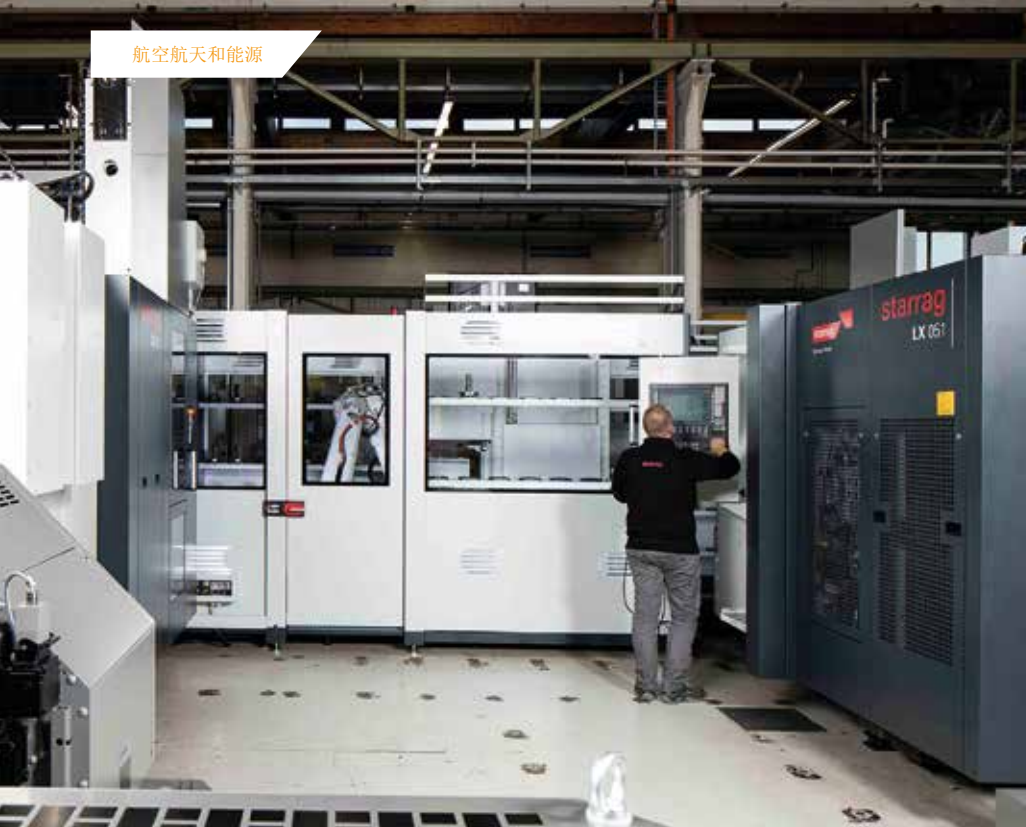
为解决这一问题，Swiss 工厂研发人员选择采用 LX 051 机床。该系列机床是斯达拉格专为涡轮叶片的高精度五轴联动加工而开发。
