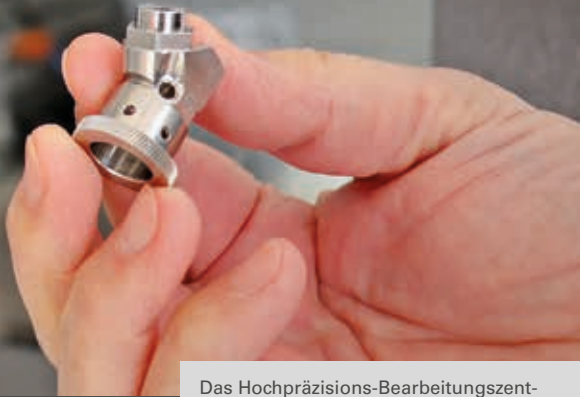
Das Hochpräzisions-Bearbeitungszentrum Bumotec s191 linear zeigte an einem mikromechanischen Musterteil seine vielfältigen Bearbeitungsmöglichkeiten.
