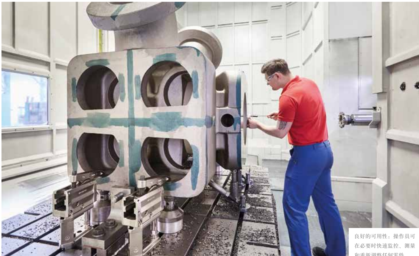
保护仓：全密闭护罩对于布克哈德压缩机非常重要，因为他们加工大量铸件，会产生非常多的金属粉尘。员工也得到防护，避免接触冷却剂蒸气。
