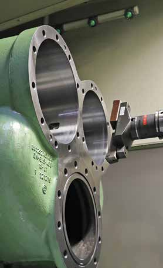
海科特 HEC 630 和 HEC 800 加工中心的重要优势：超大工作区，带加工深孔用的镗杆，过程十分可靠。
