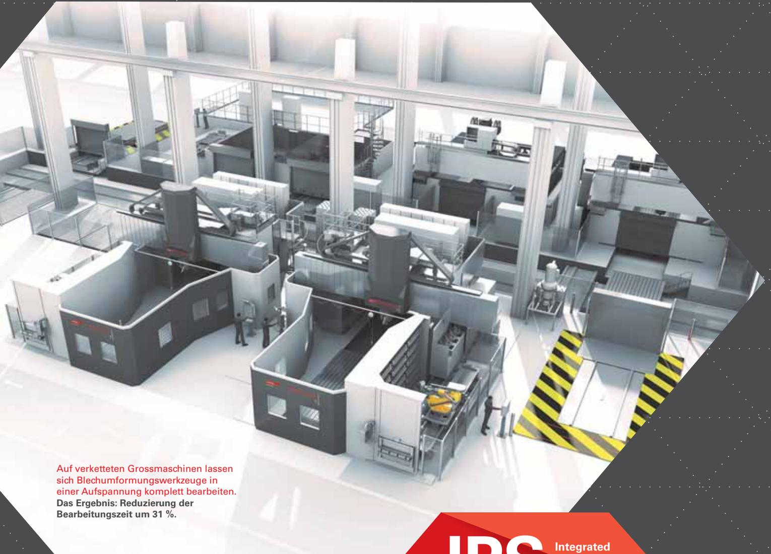
Auf verketteten Grossmaschinen lassen sich Blechumformungswerkzeuge in einer Aufspannung komplett bearbeiten. Das Ergebnis: Reduzierung der Bearbeitungszeit um 31 %.
