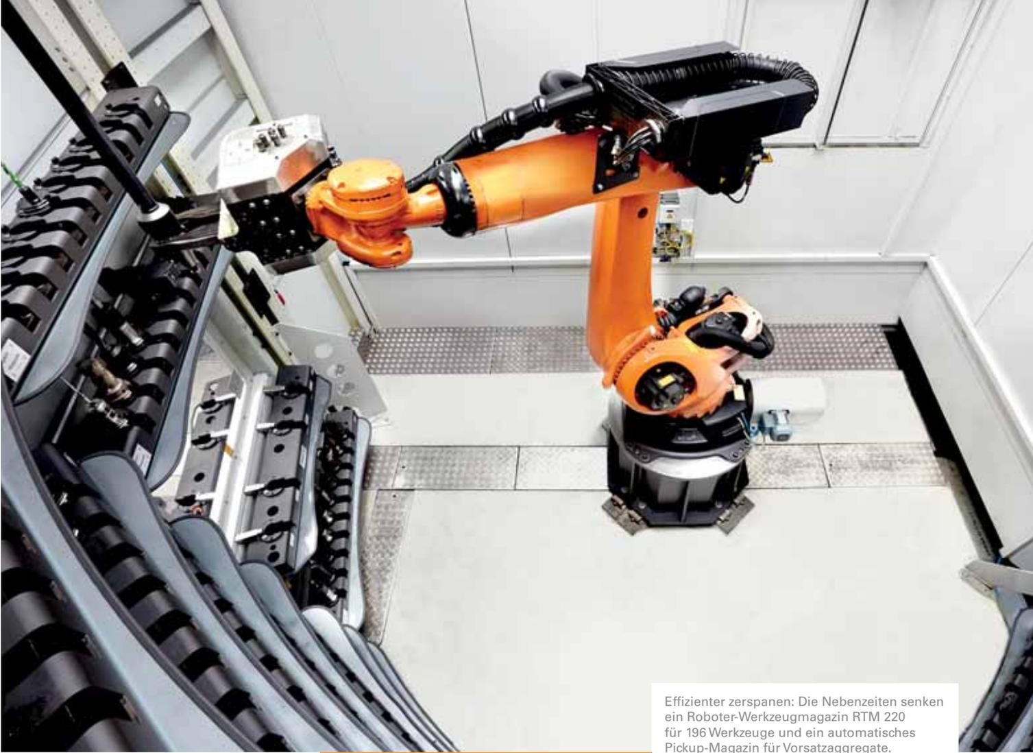
Effizienter zerspanen: Die Nebenzeiten senken ein Roboter-Werkzeugmagazin RTM 220 für 196 Werkzeuge und ein automatisches Pickup-Magazin für Vorsatzaggregate.
