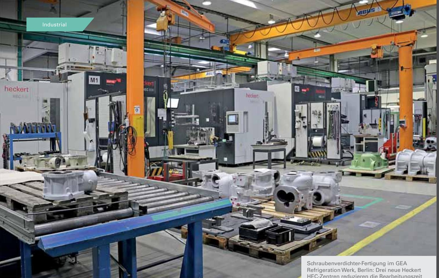
Schraubenverdichter-Fertigung im GEA Refrigeration Werk, Berlin: Drei neue Heckert HEC-Zentren reduzieren die Bearbeitungszeit für die Gehäuse um rund 40%.
