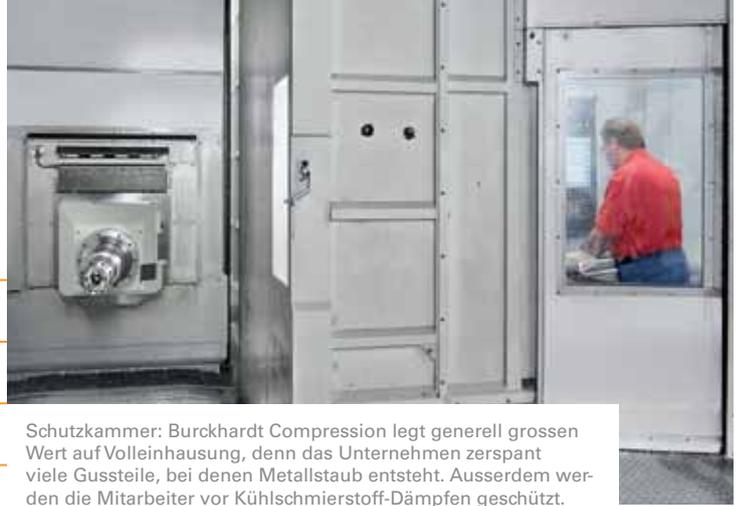
Schutzkammer: Burckhardt Compression legt generell grossen Wert auf Volleinhausung, denn das Unternehmen zerspannt viele Gussteile, bei denen Metallstaub entsteht. Ausserdem werden die Mitarbeiter vor Kühlschmierstoff-Dämpfen geschützt.
