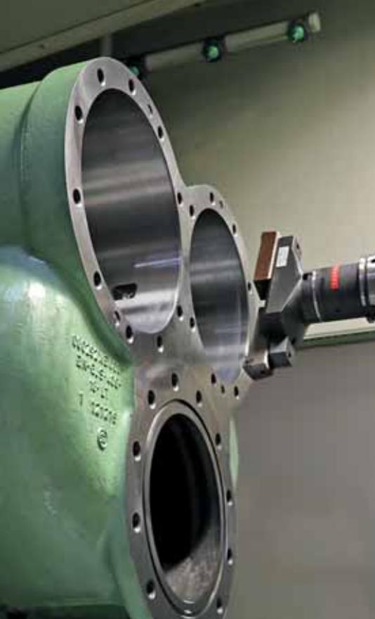
Wichtige Pluspunkte der Heckert-Bearbeitungszentren HEC 630 und HEC 800: der grosse Arbeitsraum und die Pinole, mit der sich tiefe Passbohrungen prozesssicher ausführen lassen.
