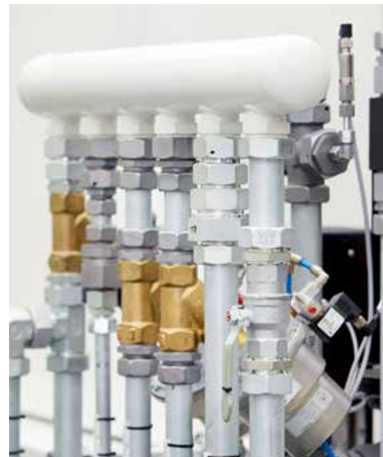
优良的加工环境： 在这其中，优化的冷却液供应起着决定性作用，使系统在高达 7,500 rpm 的速度下仍能确保恒定的温度，并且大大改善了排屑效果。
