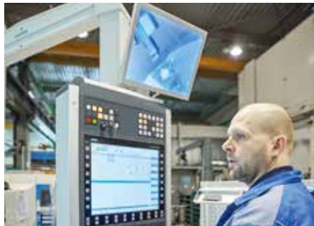
加工过程尽收眼底： 大部分加工工作都在内轮廓上进行，如果没有内置视频系统，和马蒂亚斯·鲍尔一样的工人们在这样一个完全封闭的车床上是无法观察加工过程的。
