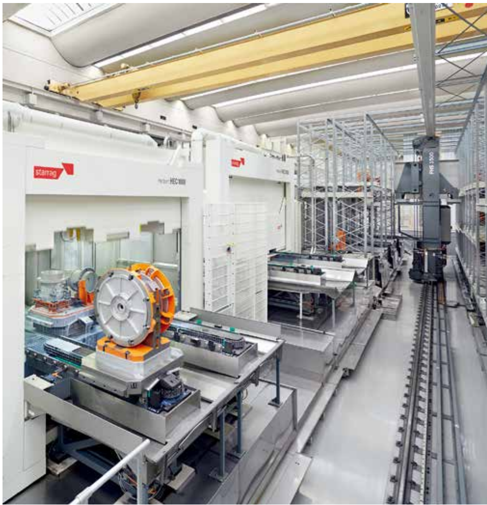
符合人体工程学的设计： 应客户要求，斯达拉格把海科特加工中心沉入地面 750 mm，目的是通过地面可及性简化搬运，由此提高生产率。
