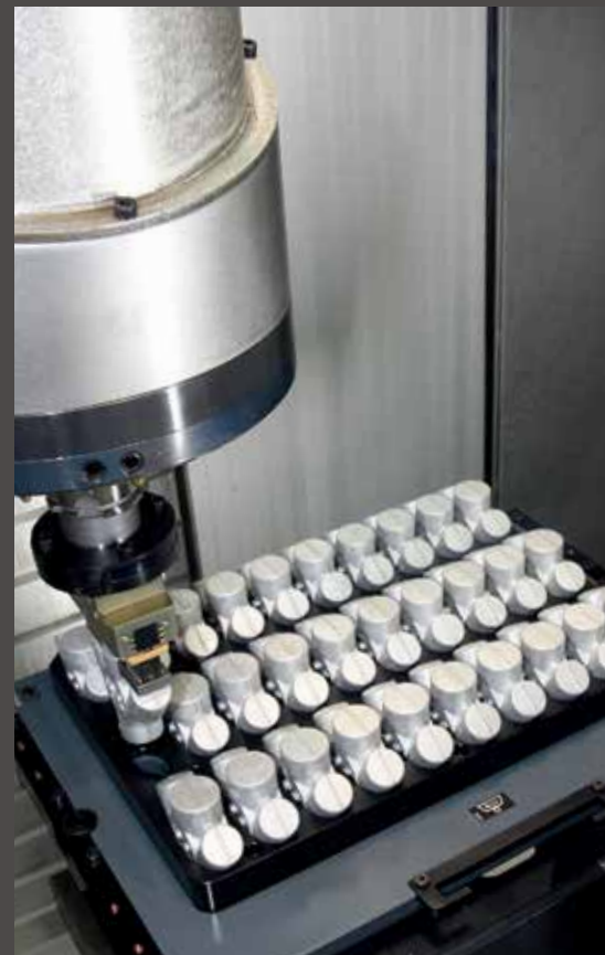
为无人值守运转做好准备： 车削零件承包商 Heinrich 特别强调高度自动化，因为在必要时 s181 要全天候运转。为此，斯达拉格为该加工中心配备了一个自动刀具和工件交换系统。
