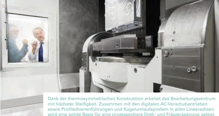
Dank der thermosymmetrischen Konstruktion arbeitet das Bearbeitungszentrum mit höchster Steifigkeit. Zusammen mit den digitalen AC-Vorschubantrieben sowie Profilschienenführungen und Kugelumlaufspindeln in allen Linearachsen wird eine solide Basis für eine prozesssichere Dreh- und Fräzerspanung gelegt.
