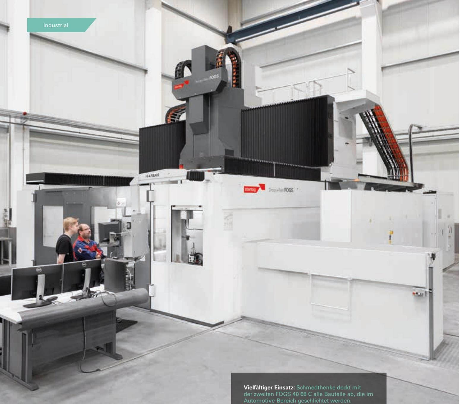
**Vielfältiger Einsatz:** Schmedthenke deckt mit der zweiten FOGS 40 68 C alle Bauteile ab, die im Automotive-Bereich geschliffen werden.
