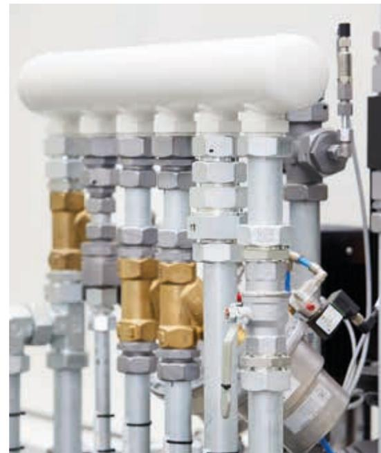
**Prima Zerspanungsklima:** Eine entscheidende Rolle spielt die optimierte Versorgung mit Kühlschmiermittel, die auch bei hohen Drehzahlen von bis zu 7.500 min<sup>-1</sup> für konstante Temperaturen sorgt und die den Abtransport der Späne deutlich verbessert.
