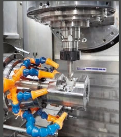
**Besonders effektiv:** Die innere Kühlschmiermittelzufuhr durchs Werkzeug und die externe Kühlung sparen Heinrich bei Aluminium echte Sekunden ein und sorgen so für mehr Produktivität.
