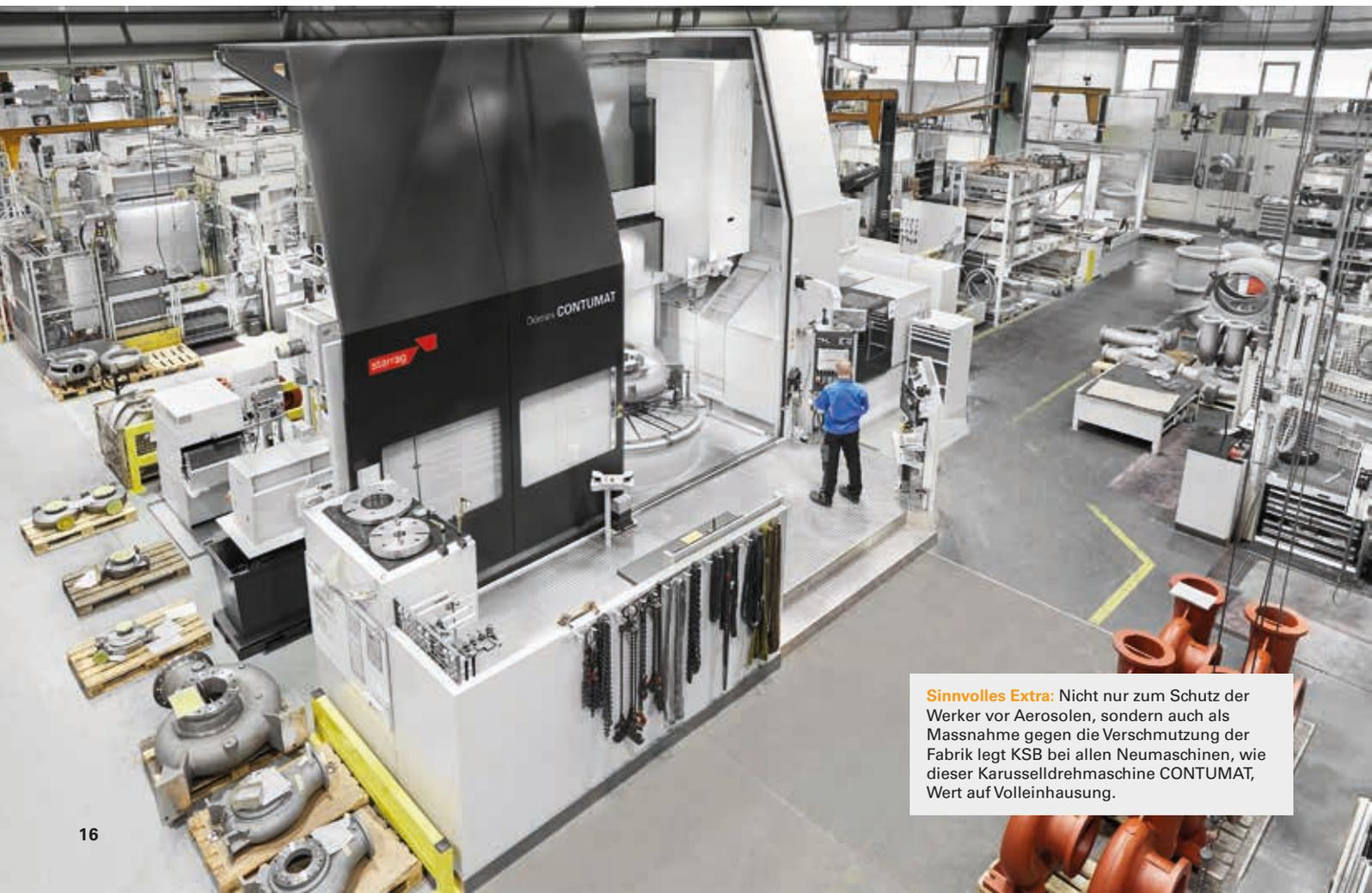
**Sinnvolles Extra:** Nicht nur zum Schutz der Werker vor Aerosolen, sondern auch als Massnahme gegen die Verschmutzung der Fabrik legt KSB bei allen Neumaschinen, wie dieser Karusselldrehmaschine CONTUMAT, Wert auf Volleinhausung.
