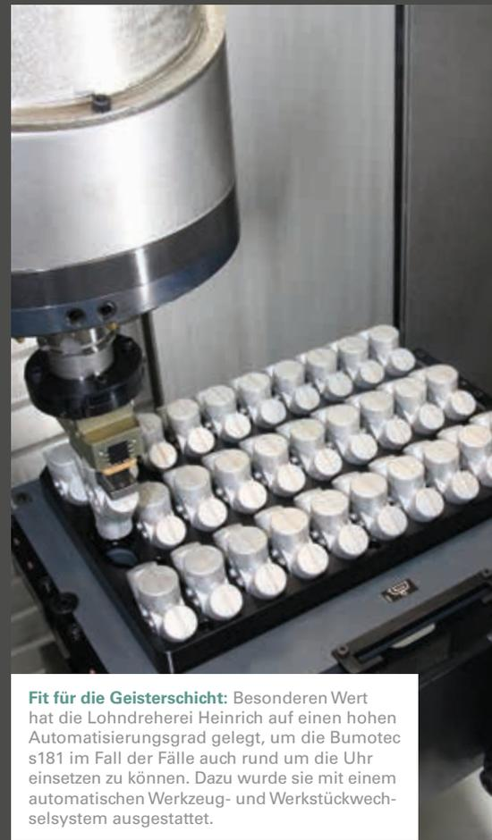
**Fit für die Geisterschicht:** Besonderen Wert hat die Lohndreherei Heinrich auf einen hohen Automatisierungsgrad gelegt, um die Bumotec s181 im Fall der Fälle auch rund um die Uhr einsetzen zu können. Dazu wurde sie mit einem automatischen Werkzeug- und Werkstückwechselsystem ausgestattet.
