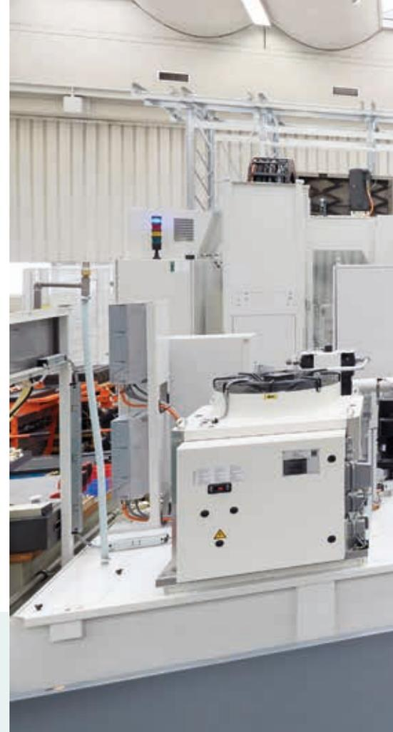
**Flexibel:** Die neue Anlage mit vier Heckert-Bearbeitungszentren kann im Schnitt pro Tag mit insgesamt 960 Werkzeugen Werkstücke komplett bearbeiten.
