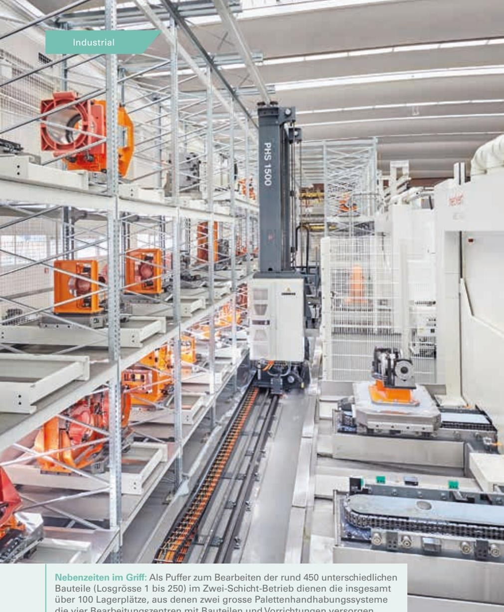
**Nebenzeiten im Griff:** Als Puffer zum Bearbeiten der rund 450 unterschiedlichen Bauteile (Losgrösse 1 bis 250) im Zwei-Schicht-Betrieb dienen die insgesamt über 100 Lagerplätze, aus denen zwei grosse Palettenhandhabungssysteme die vier Bearbeitungszentren mit Bauteilen und Vorrichtungen versorgen.
