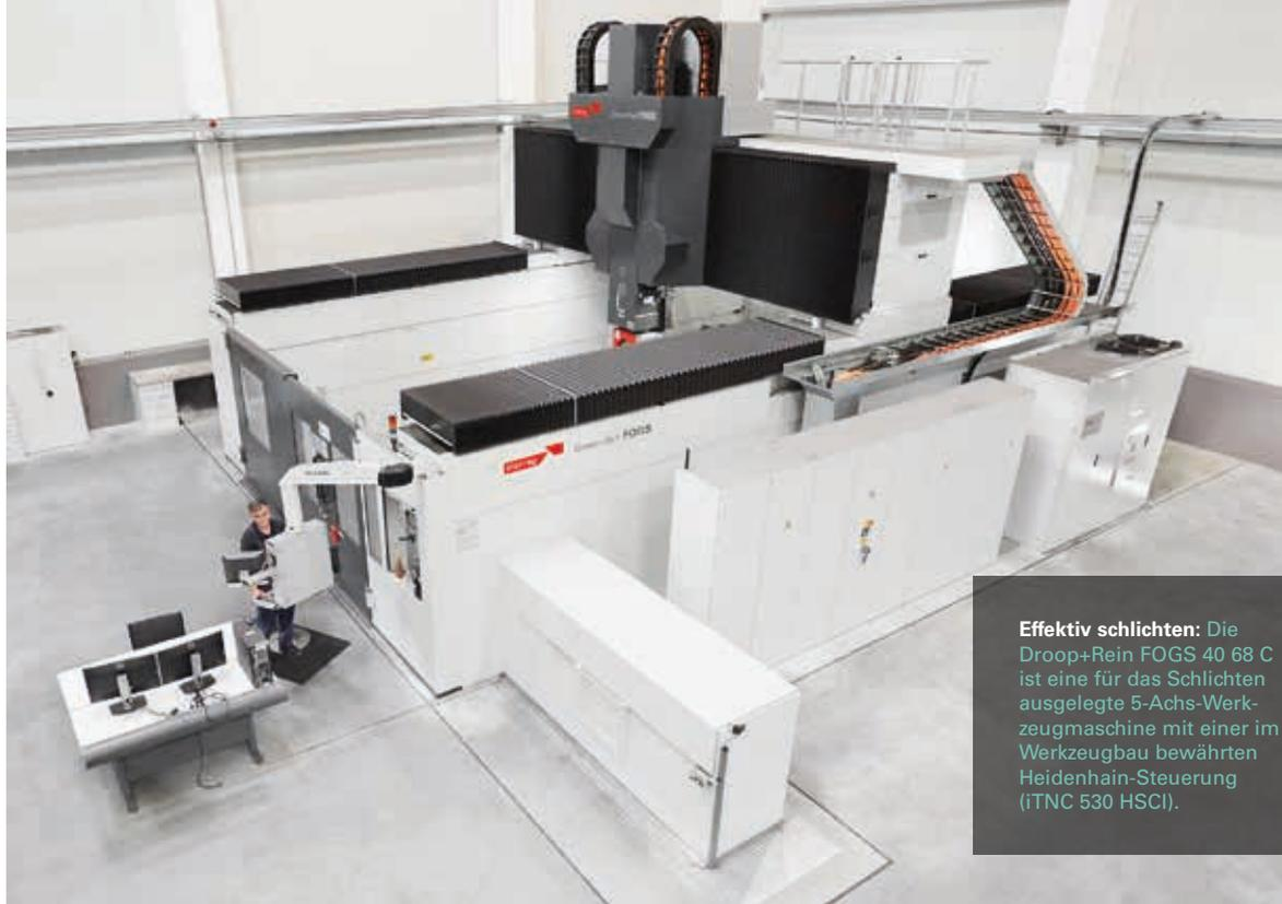
**Effektiv schlichten:** Die DROOP+REIN FOGS 40 68 C ist eine für das Schlichten ausgelegte 5-Achs-Werkzeugmaschine mit einer im Werkzeugbau bewährten Heidenhain-Steuerung (iTNC 530 HSCI).
