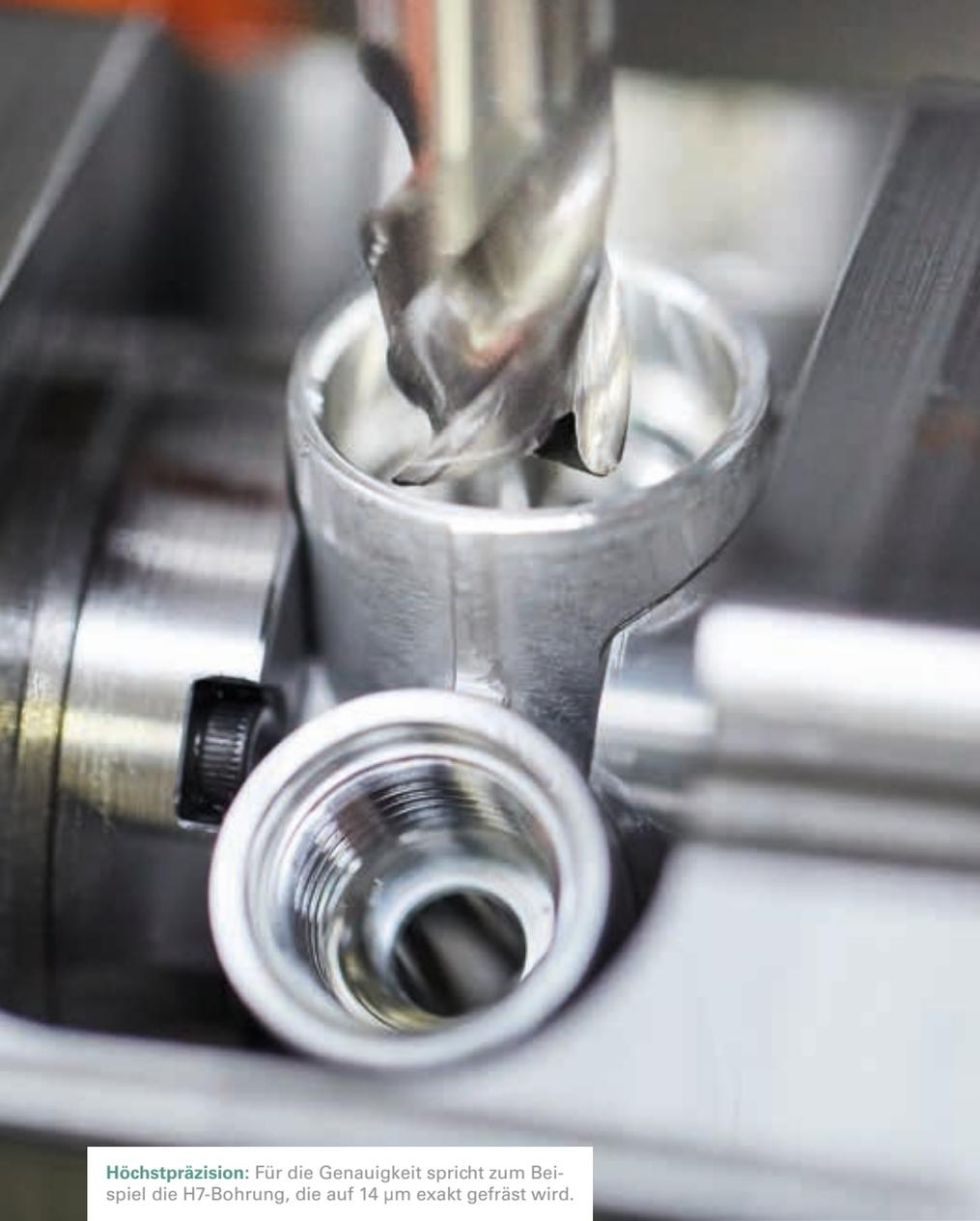
**Höchstpräzision:** Für die Genauigkeit spricht zum Beispiel die H7-Bohrung, die auf 14 µm exakt gefräst wird.
