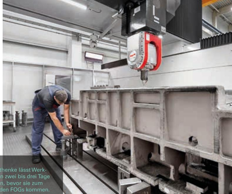
**In Warteposition:** Schmedthenke lässt Werkzeuge nach dem Schruppen zwei bis drei Tage auskühlen und entspannen, bevor sie zum Schlichten auf eine der beiden FOGs kommen.
