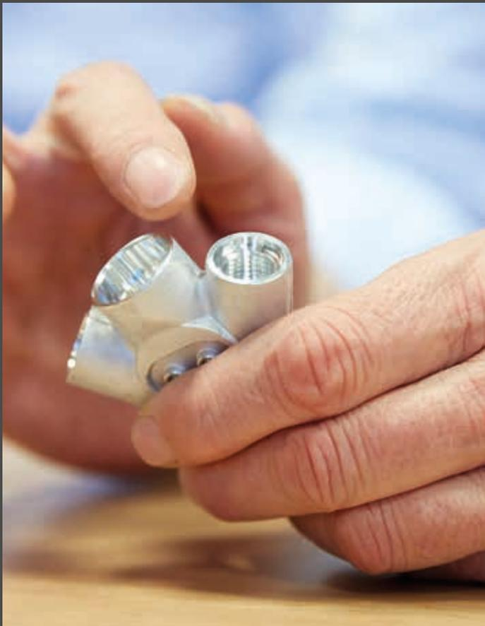
**VEREDLUNGSPROZESS:** Das neue Bauteil verbindet als Herzstück die Sauerstoffflasche mit der Atemschutzmaske. Als Ausgangsmaterial dient ein Schmiederohling aus einer speziellen, siliziumhaltigen Aluminiumlegierung (AlSi05). Heinrich erlaubt sich sogar den fertigungstechnischen Luxus, das Bauteil nicht nur innen, sondern auch aussen komplett zu entgraten und anschliessend zu eloxieren.
