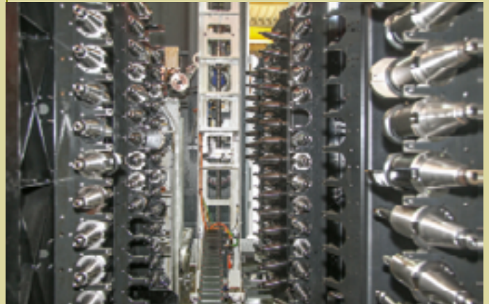
塔式刀库可容纳 300 多种长度达 800 mm 的刀具。
