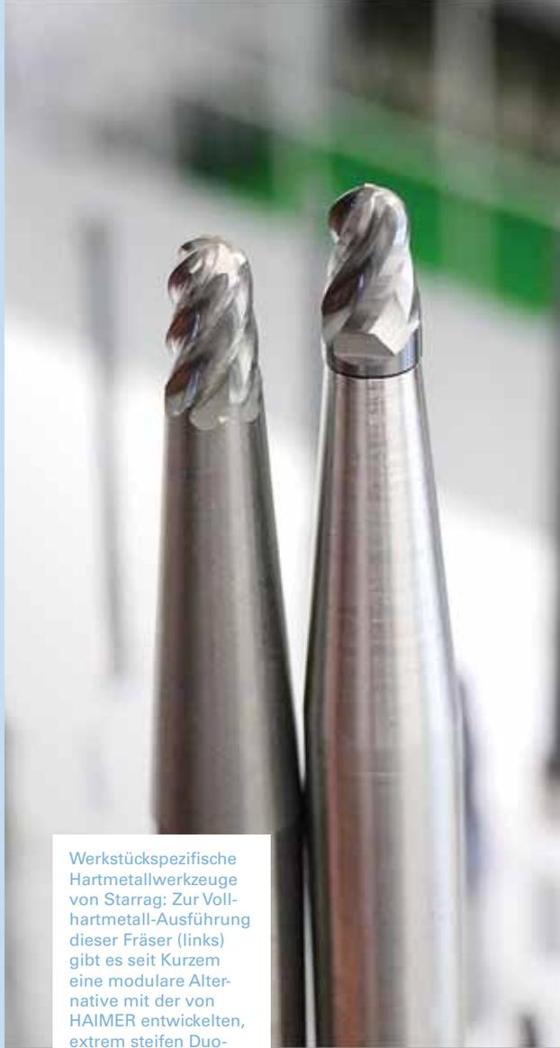
Werkstückspezifische Hartmetallwerkzeuge von Starrag: Zur Vollhartmetall-Ausführung dieser Fräser (links) gibt es seit Kurzem eine modulare Alternative mit der von HAIMER entwickelten, extrem steifen Duo-Lock™-Schnittstelle.
