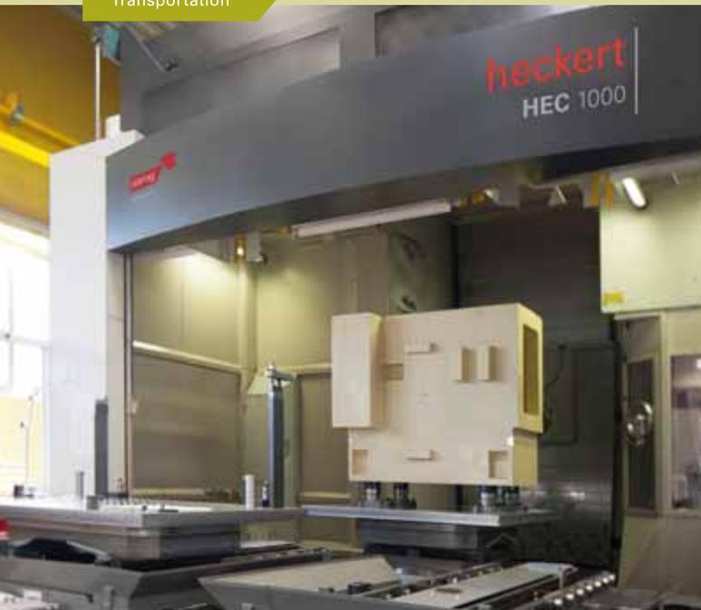
Aufgrund des geringen Platzangebotes musste man für die Konfiguration der X-Achse auf ein Heckert HEC 1000 Grundsystem aufbauen. Die anderen Achsen werden aus Komponenten der Heckert HEC 1250 gebildet.
