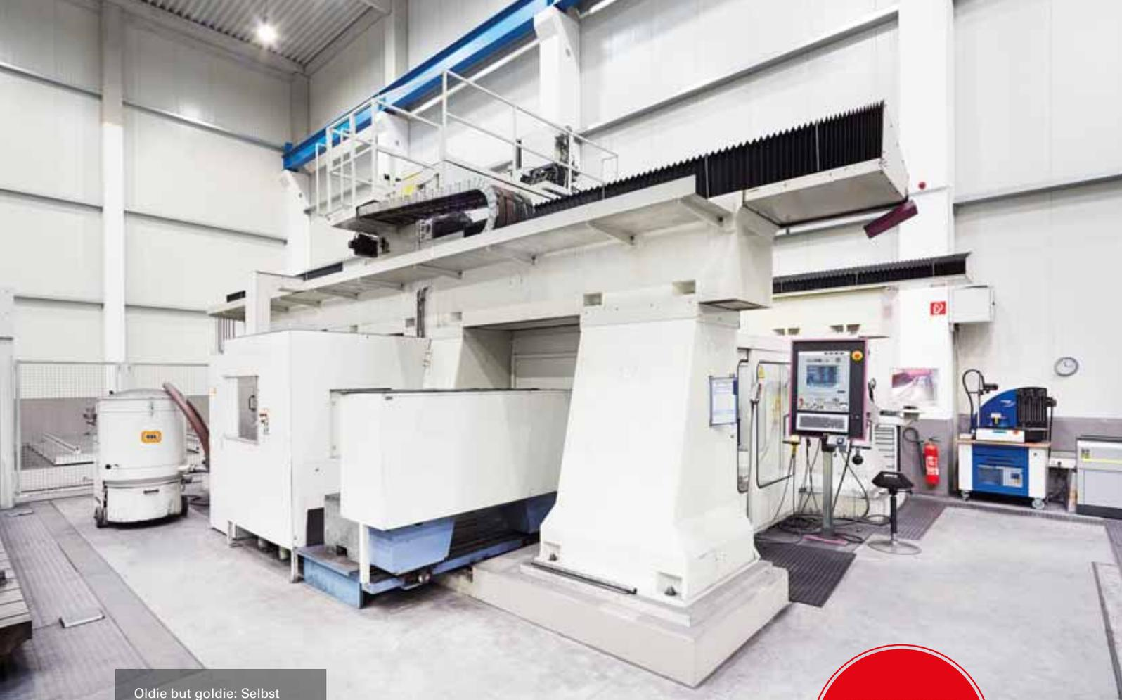
Oldie but goldie: Selbst Maschinen der ersten Stunde (im Bild eine FOG 2500) eignen sich nach dem Retrofit für weiteren jahrelangen, produktiven Einsatz.
