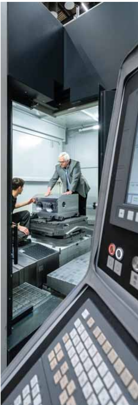
Vorbereitet auf den mannlosen Betrieb: Das neue Bearbeitungszentrum Heckert DBF 1000 kann mittels eines zusätzlichen 6-Paletten-Linearspeichers und einem 320er Werkzeugmagazin auch mannlos arbeiten.
