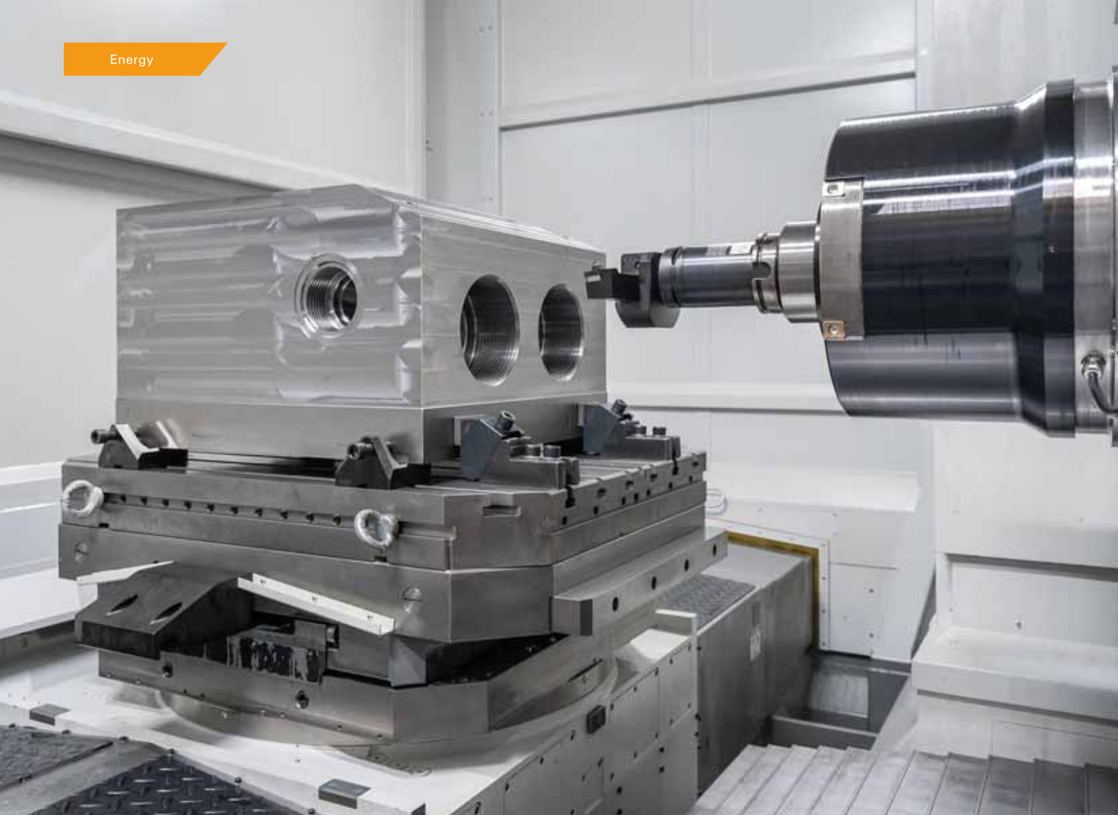
»Heavy Metal« im Visier: Für das hocheffiziente Schwerzerspanen von bis zu 4.000 kg schweren Gehäusen, zum Beispiel Fluid Ends, eignet sich das Bearbeitungszentrum Heckert DBF 1000.
