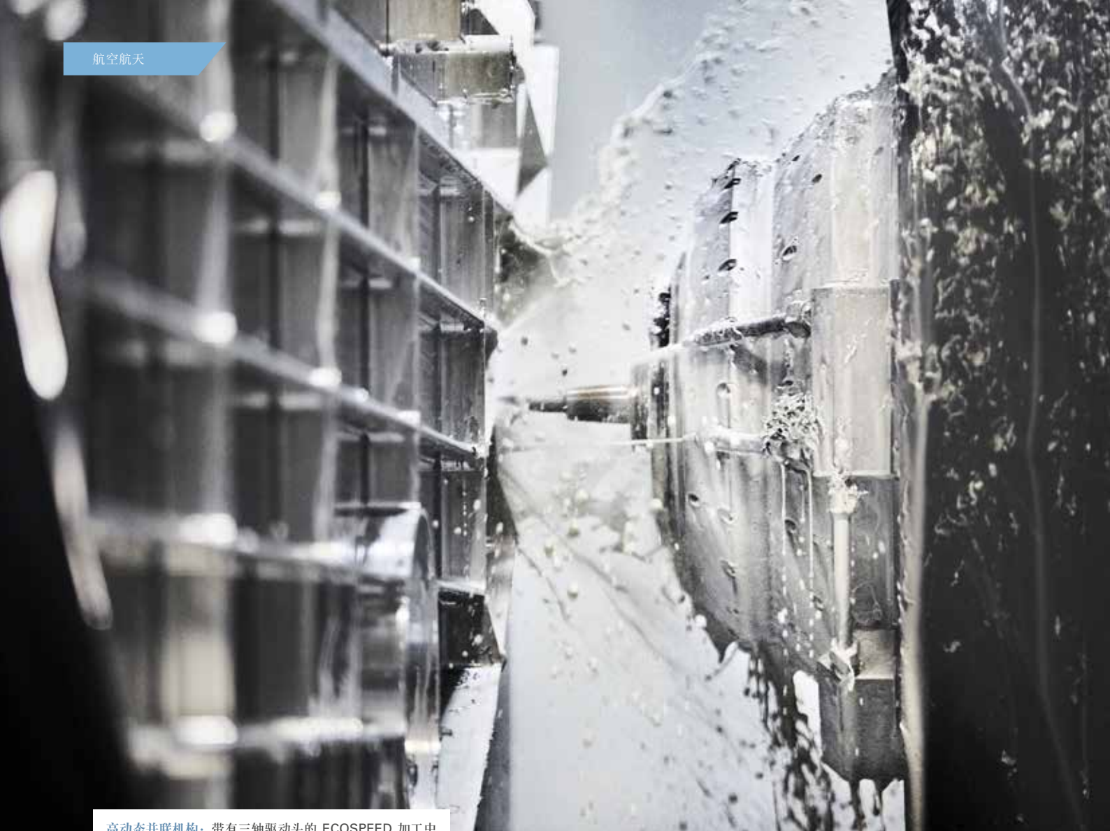
高动态并联机构： 带有三轴驱动头的 ECOSPEED 加工中心主导了 Premium AEROTEC 公司的大型部件的生产。
