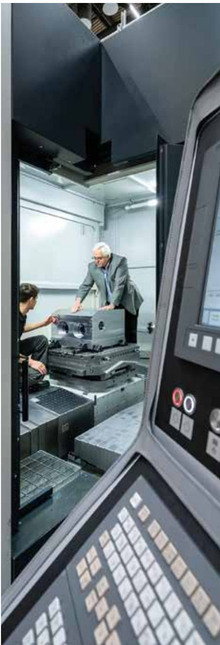
为无人值守准备： 集成了六个托盘线性存储系统和 320-ATC 换刀装置的海科特 DBF 1000 加工中心也可以在无人干预的情况下工作。
