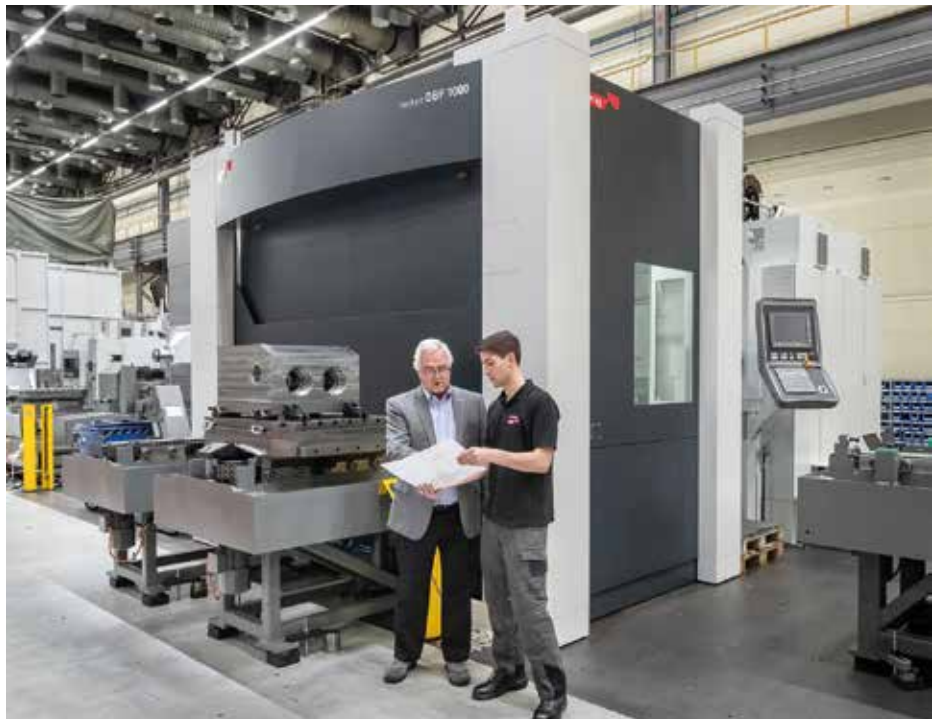
为无人值守准备： 集成了六个托盘线性存储系统和 320-ATC 换刀装置的海科特 DBF 1000 加工中心也可以在无人干预的情况下工作。
