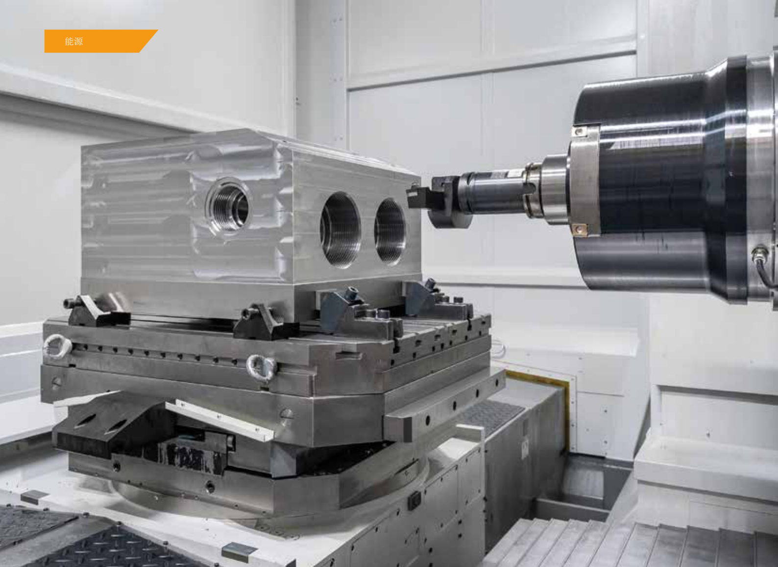
看得见的“重金属” ：全新海科特 DBF 1000 加工中心尤其适用于高达 4,000 kg 的重型壳体的高效重型切削，比如流体端。
