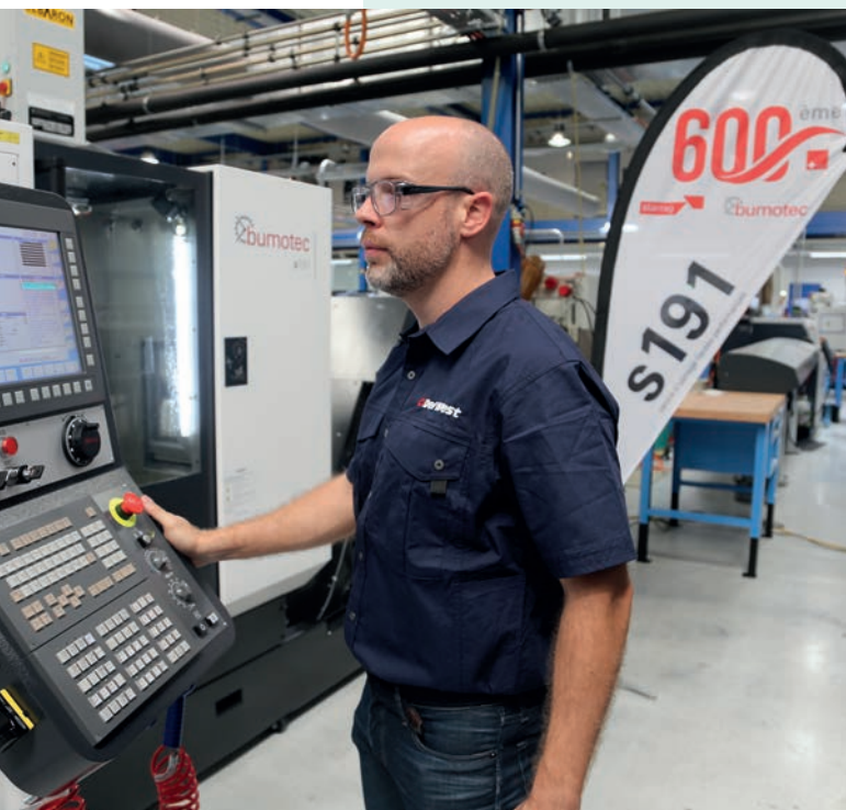
Das s191-Bearbeitungszentrum bietet komplette Bearbeitungslösungen, die das Arbeiten mit Stangen (mit einem Durchmesser von 32/50/65 mm) oder Rohlingen ermöglicht und schnelle Linearachsen sowie eine Spindel mit 30.000 U/min in weniger als zwei Sekunden, insgesamt sieben Achsen, drei Spindeln und 90 Werkzeuge offeriert. Es ist also kurz gesagt das Nonplusultra unter den Werkzeugmaschinen.
