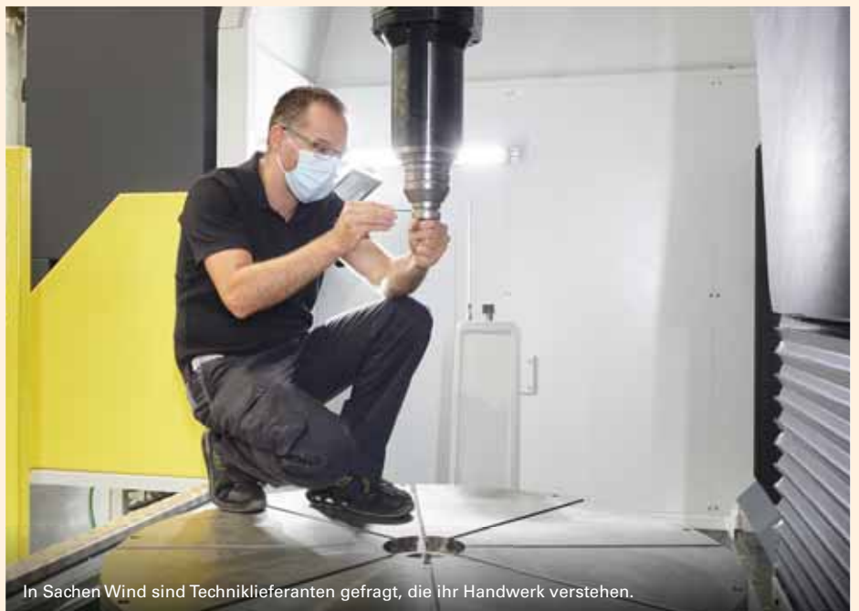
RVU 2800/250 2C: Dank doppeltem Schlitteneinsatz reduziert sich die Bearbeitungszeit um 20%.
