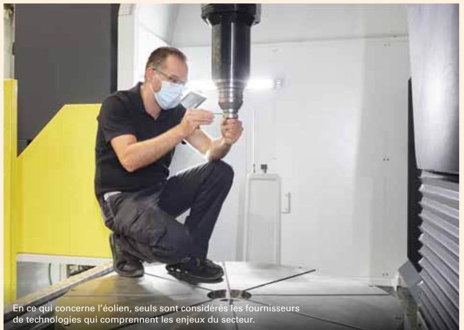
RVU 2800/250 2C : Grâce à l'utilisation simultanée de deux chariots, le temps d'usinage est réduit de 20 %.
