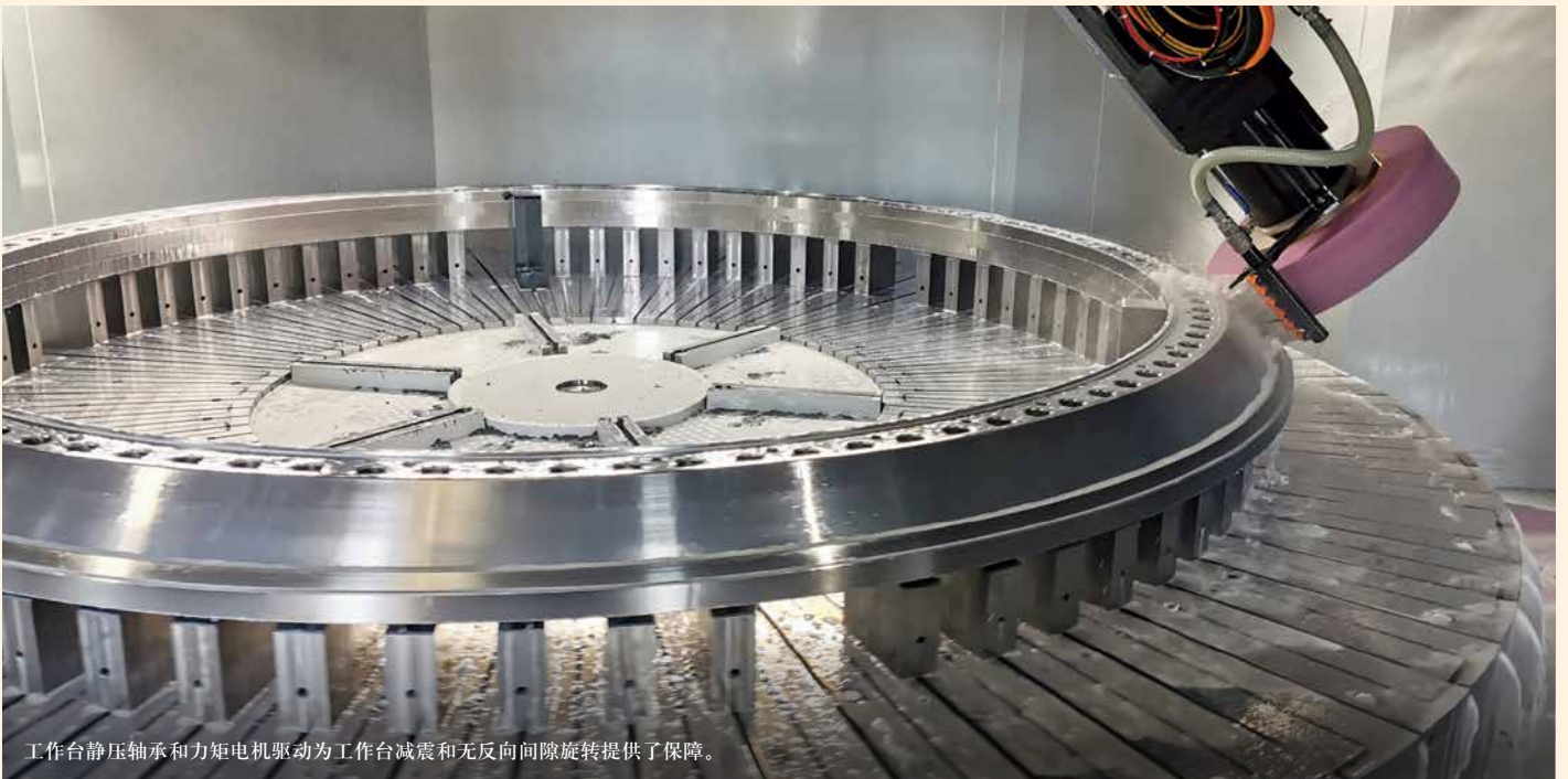
高质量的驱动技术实现了高加工精度。
