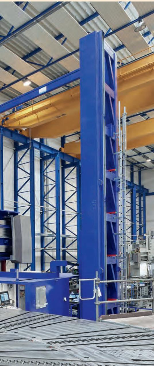
**来自丹麦的超大订单：**目前正在比勒菲尔德建造一台龙门铣床，这台铣床甚至可以对由高强度焊接不锈钢和铸铁结构制成的超大型工件进行强力车削、铣削和钻孔。
