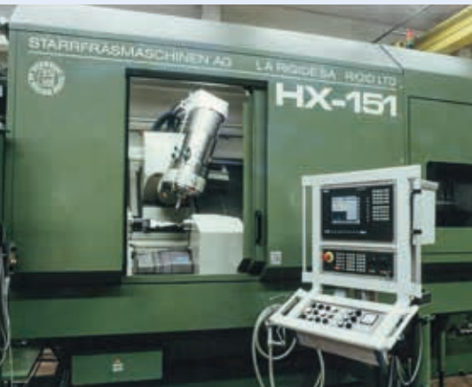
Tempo, Tempo: Nicht nur Präzision, sondern auch Produktivität zeichnet Starrag-Produkte aus. So entstand in den 1990er-Jahren diese Hochgeschwindigkeits-Fräsmaschine des Typs HX-151, mit der ABB Turbinenschaufeln fräst.
