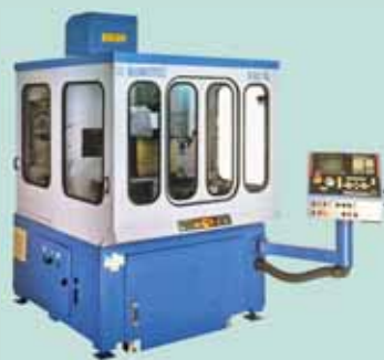
Bumotec S-92XL, CNC de 3 à 5 axes en configuration monobroche ou multibroches, produites au début des années 90.
