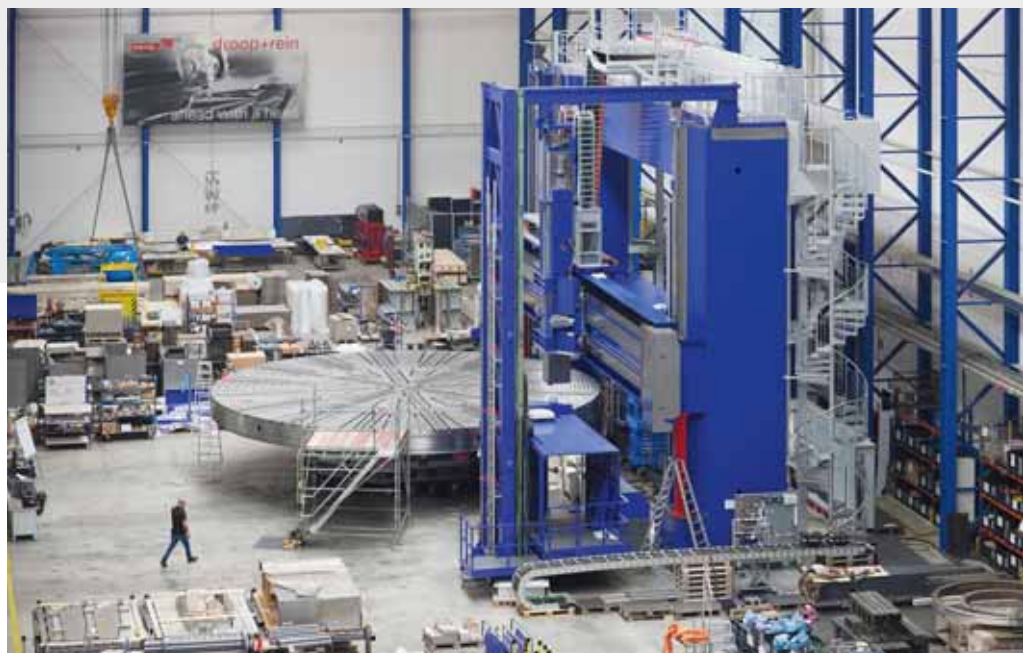
Format XXL : les produits LPMS, comme cette fraiseuse à portique Gantry, font référence dans la construction de grandes machines, en termes de performance, de précision et de stabilité à long terme.
