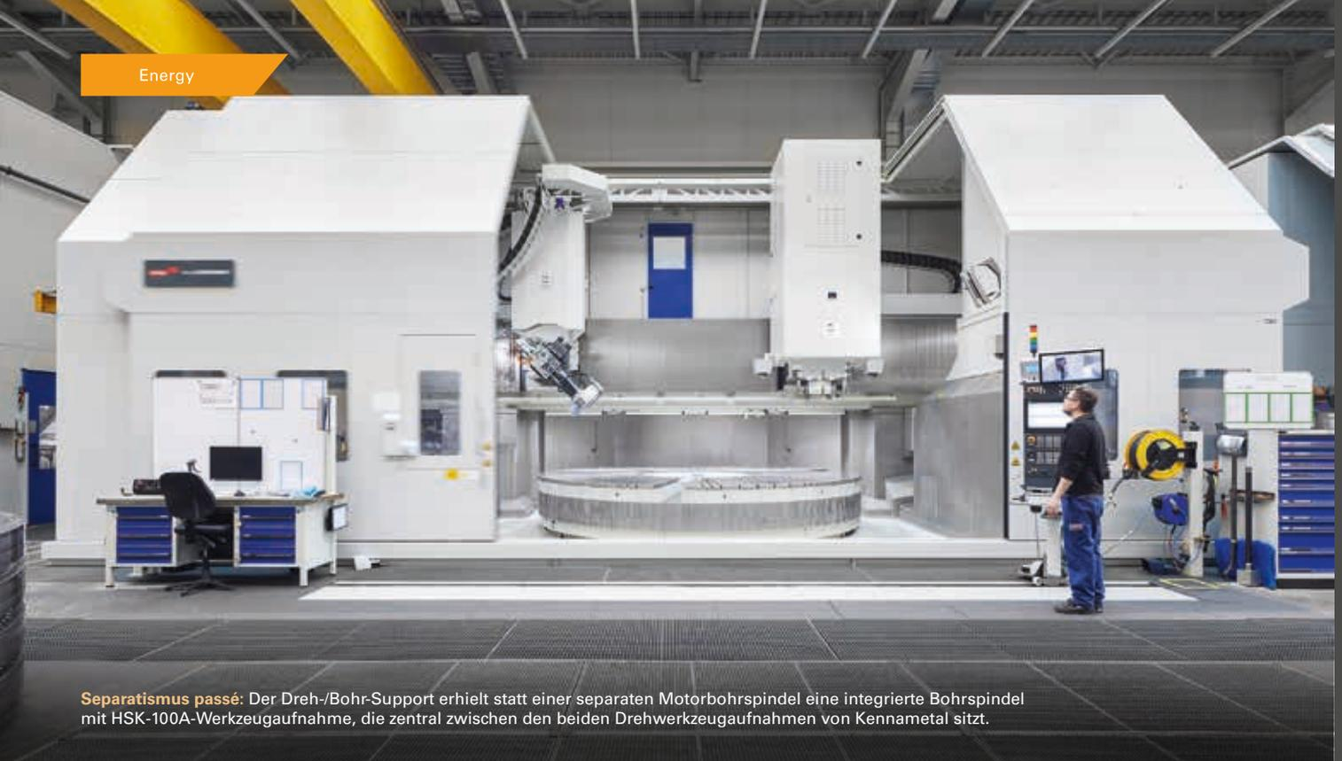
**Separatismus passé:** Der Dreh-/Bohr-Support erhielt statt einer separaten Motorbohrspindel eine integrierte Bohrspindel mit HSK-100A-Werkzeugaufnahme, die zentral zwischen den beiden Drehwerkzeugaufnahmen von Kennametal sitzt.
