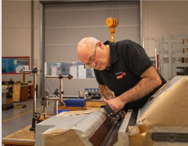
Schaben ist eine Fertigkeit, die SIP von Beginn an entwickelt hat.
