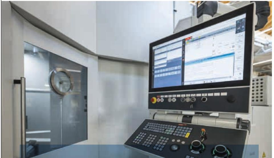
Mit der hydrostatischen STC 1250 HD gelang es, die Schruppzeit zu halbieren und die gesamte Bearbeitungszeit um insgesamt 30 % zu reduzieren.
