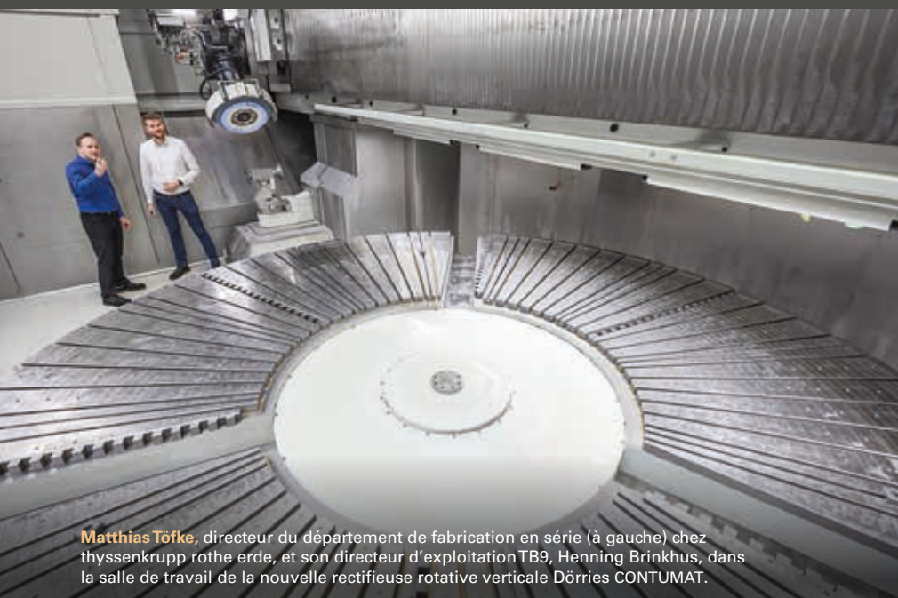
Universel : le dresseur avec ses deux disques diamantés peut être réglé individuellement en fonction de l'opération de dressage ou de rectification.
