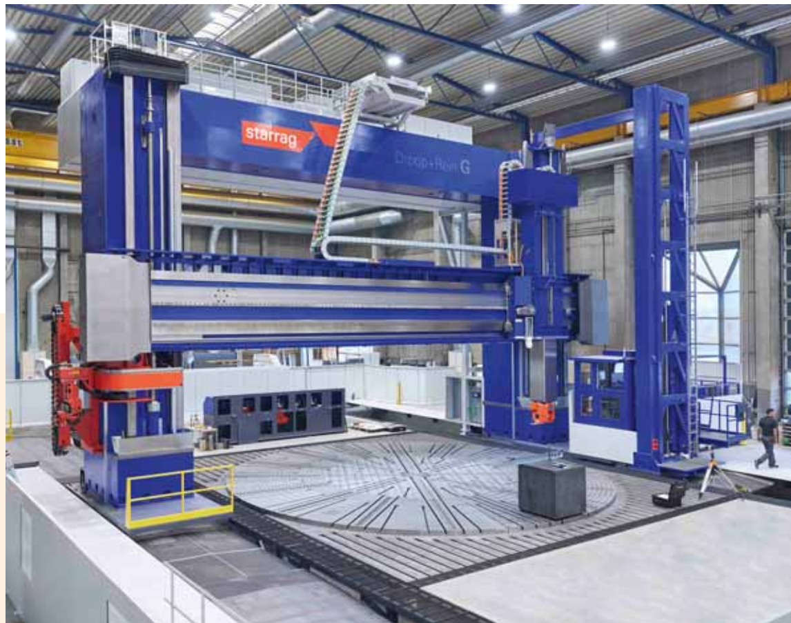
Mobiles Tor: Bei der neuen Droup+Rein-Portalfräsmaschine verfährt die Gantry-Achse über dem elf Meter breiten Drehtisch. Das Gesamtgewicht der Anlage beträgt 870 Tonnen.
