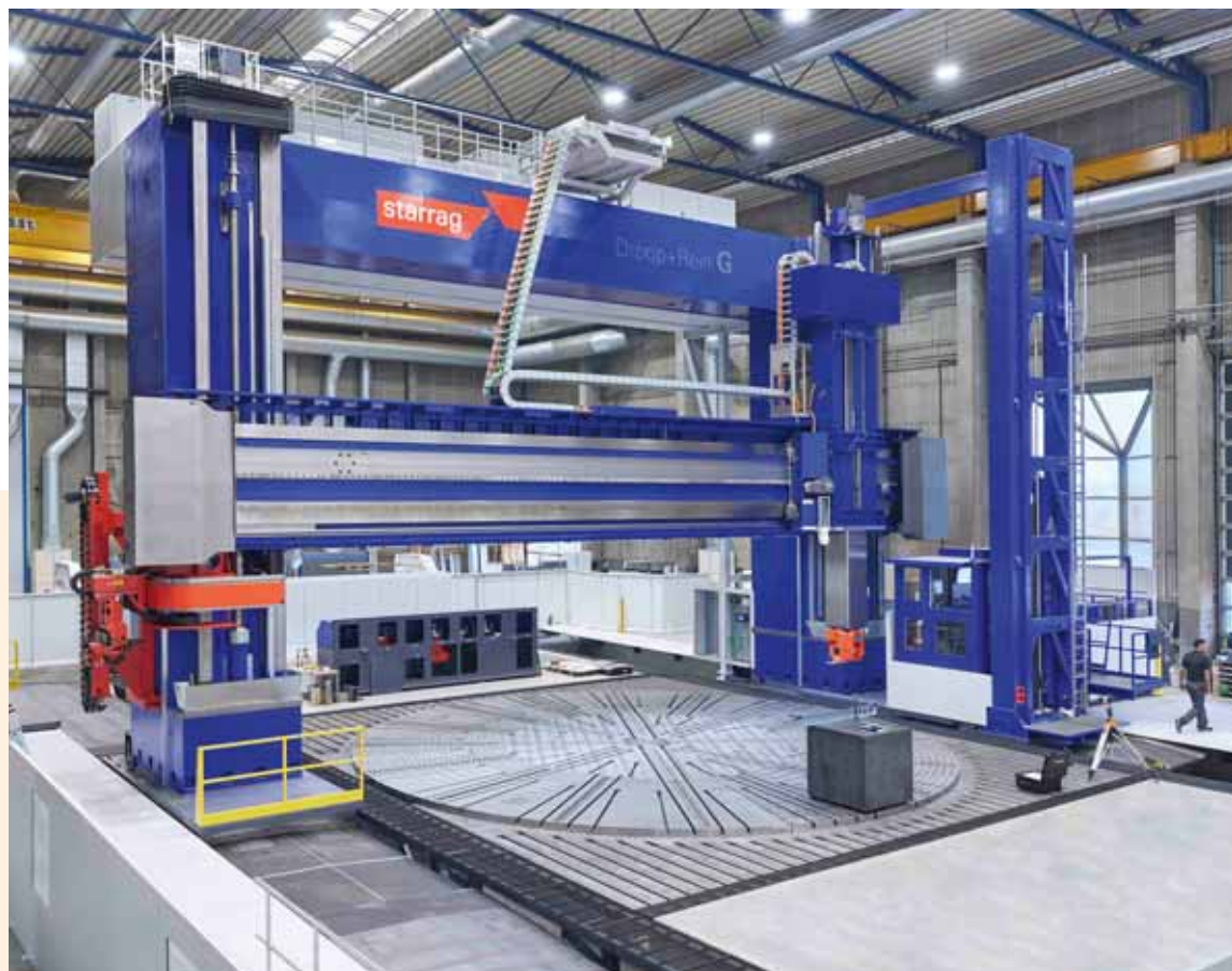
Porte mobile : Sur la nouvelle fraiseuse à portique Droop+Rein, l'axe Gantry se déplace au-dessus du plateau rotatif de onze mètres de large. Le poids total de l'installation est de 870 tonnes.
