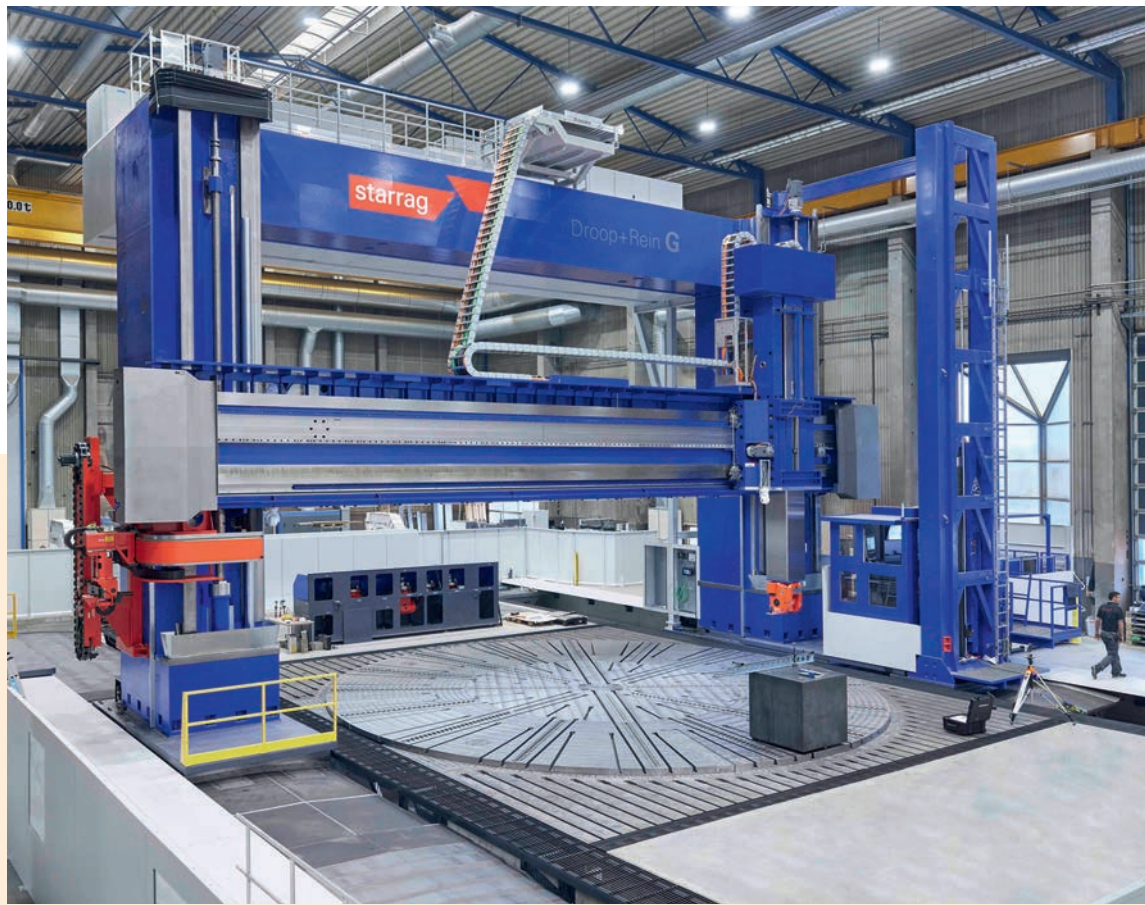
移动的希望之门： 新款杜普莱恩龙门铣床的龙门轴在 11 米宽的转台上移动。设备总重量达 870 吨。
