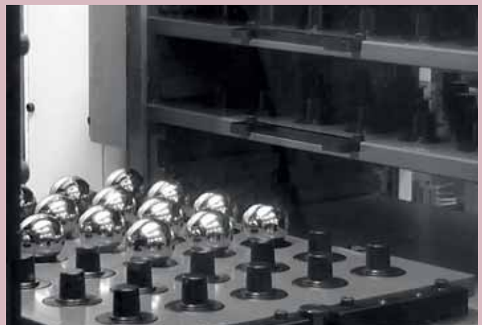
Massgeschneiderte Logistik: Das MillTrun-Bearbeitungszentrum transportiert Fertigteile ab über ein Teileband, Rutsche und/oder Ablagelösungen, die mit oder ohne Identifikation ausgestattet sind.
