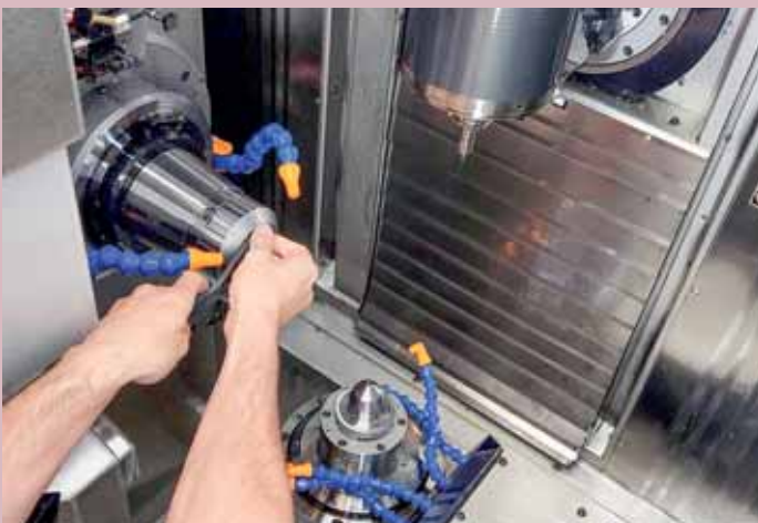
Anpassungsfähig: Grosse Teilevielfalt erfordert eine besonders flexible Maschinenkinematik mit leichter Umrüstbarkeit, dank der sich die Bearbeitungszentren ohne grossen Aufwand an verschiedene Produktionsanforderungen anpassen lassen.
