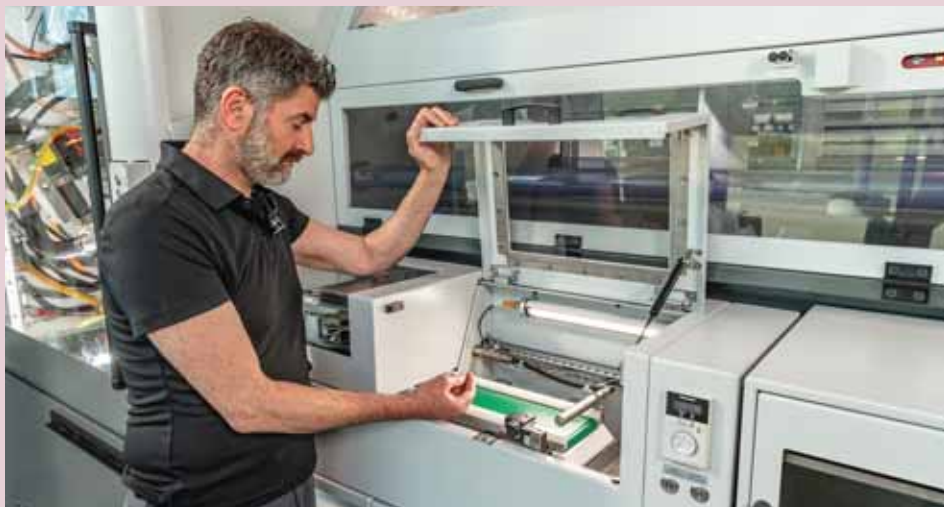
Einfacher Zugang zum Teileförderband zur Qualitätskontrolle und Entladung
