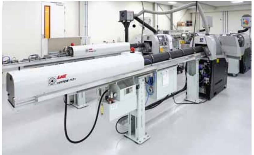
Dank des Stangenladers kann Exakt Fijnmechanika selbst grosse Serien effizient produzieren.
