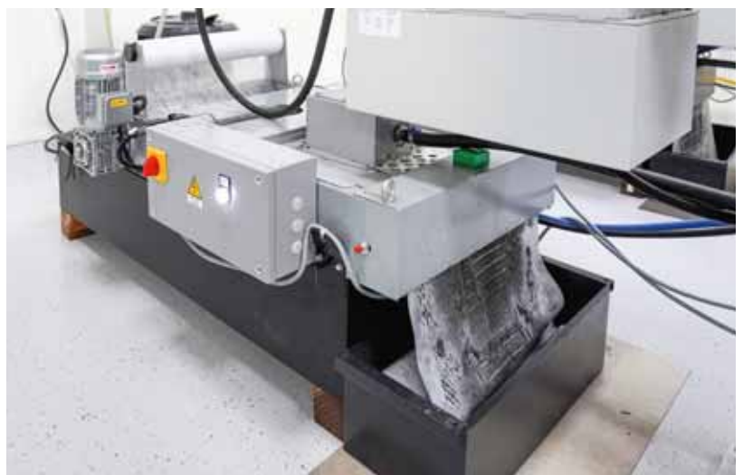
Das Papierbandfiltersystem ist eine der Lösungen, die eine hohe Prozesssicherheit garantieren.
