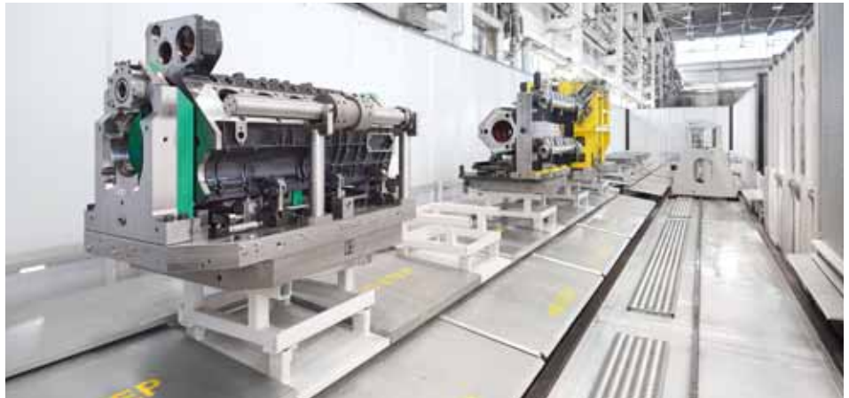
Als Automatisierungslösung wählte Tatra ein Palettenspeichersystem, das vorerst zwölf, in einem späteren Schritt dann 18 Palettenplätze und einen Linearförderer beinhaltet.
