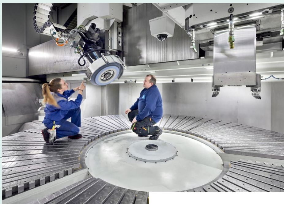
超大规格磨削加工：工作人员正在多利斯机床上调试新型磨削支架系统，用于大型滚柱轴承的高精度加工。
