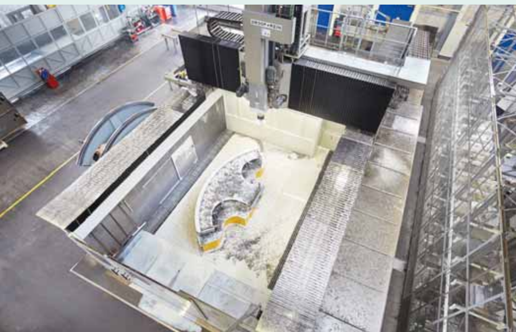
Schleifen im XXL-Format: An einer Dörries prüfen Mitarbeitende den neuen Schleifsupport für die hochpräzise Bearbeitung großer Wälzlager.
