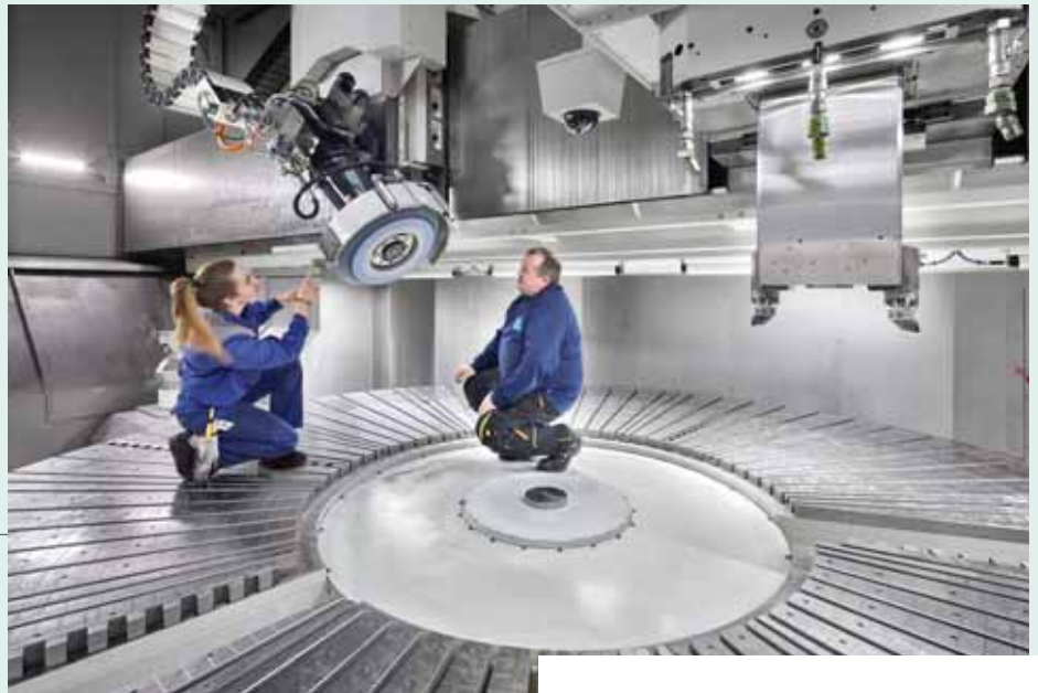
Schleifen im XXL-Format: An einer Dörries prüfen Mitarbeitende den neuen Schleifsupport für die hochpräzise Bearbeitung großer Wälzlager.
